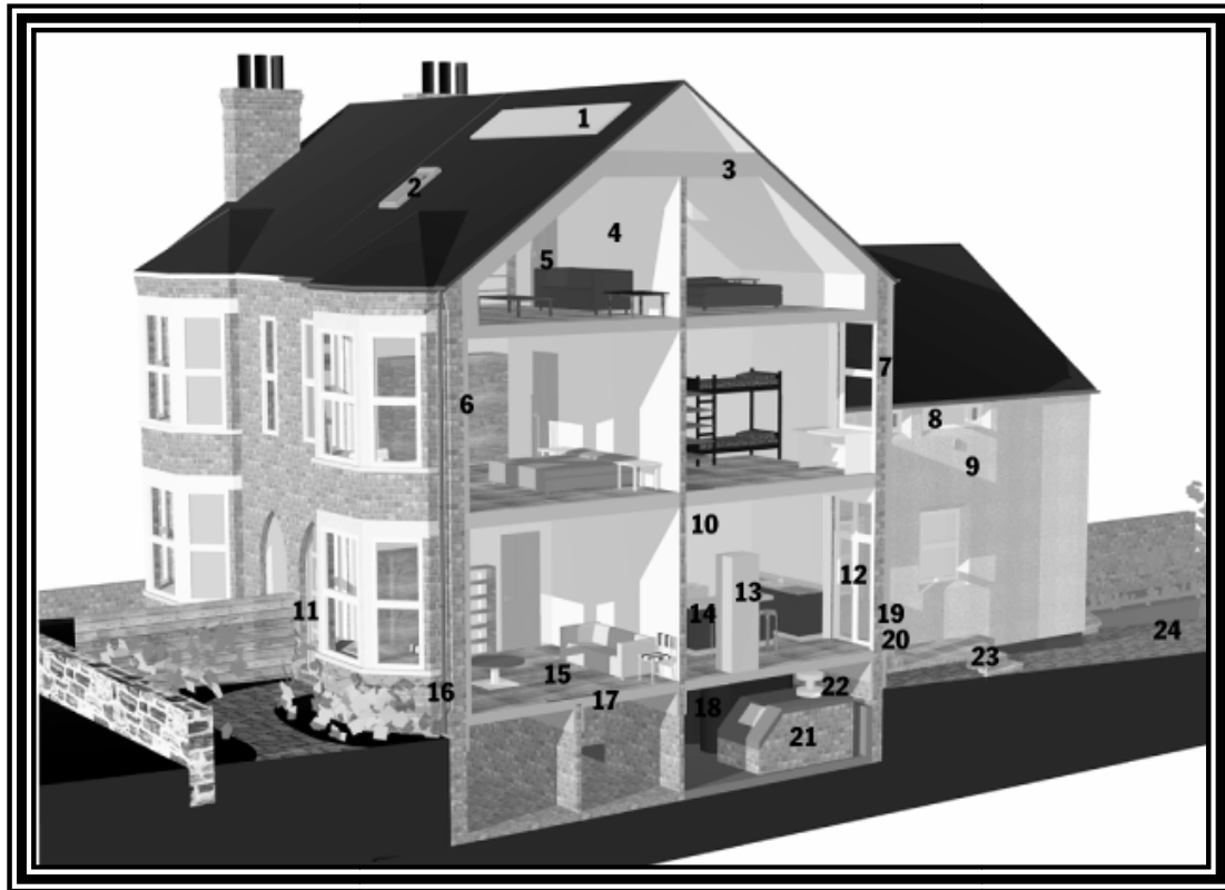
Figura 2.11 Principales partes de un tipo de casa auto sostenible (Cerde, 2008)
