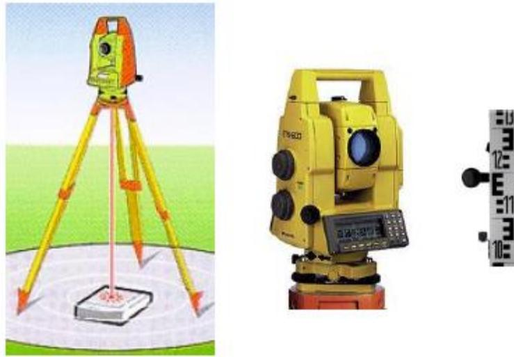
**Figura 18.** Estación total típica.
