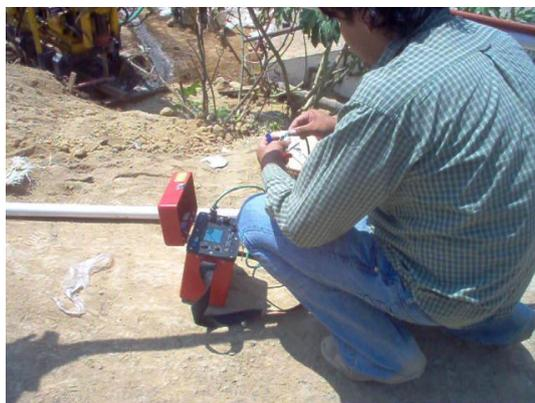
**Figura 78.** Toma de lectura cero del piezómetro de cuerda vibrante.
