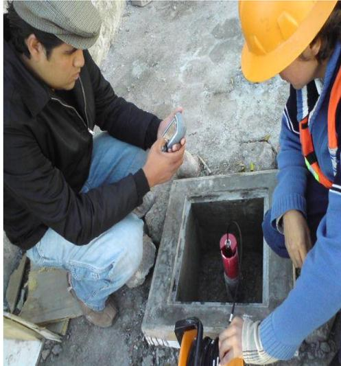
**Figura 95.** Toma de lectura de un inclinómetro.
