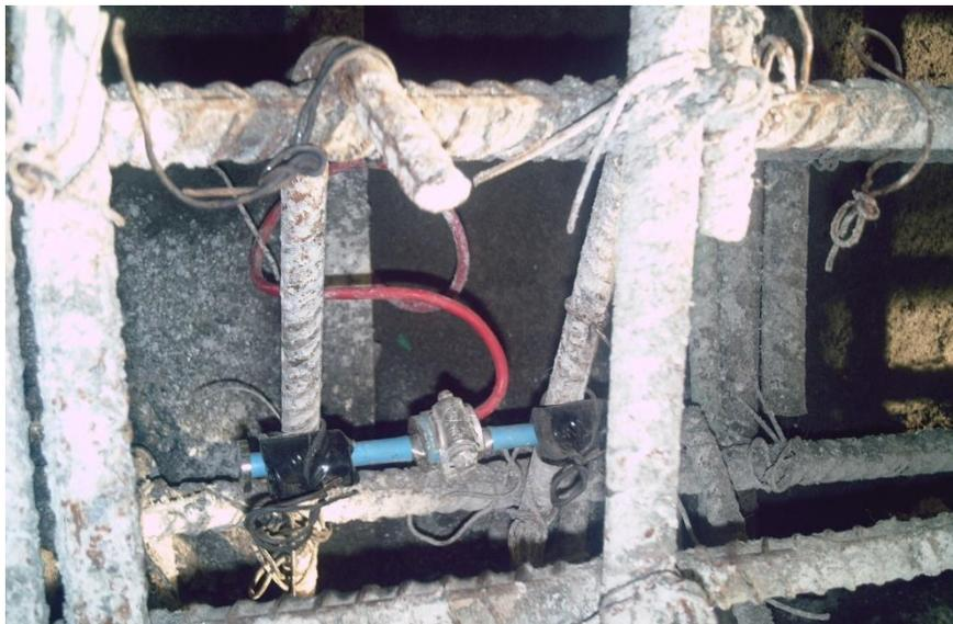
**Figura 47.** Instalación de deformímetros de concreto.
