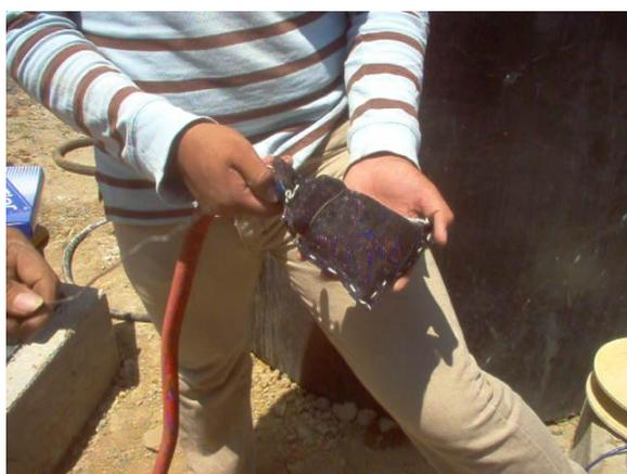
**Figura 77.** Filtro protector del Piezómetro de cuerda vibrante.
