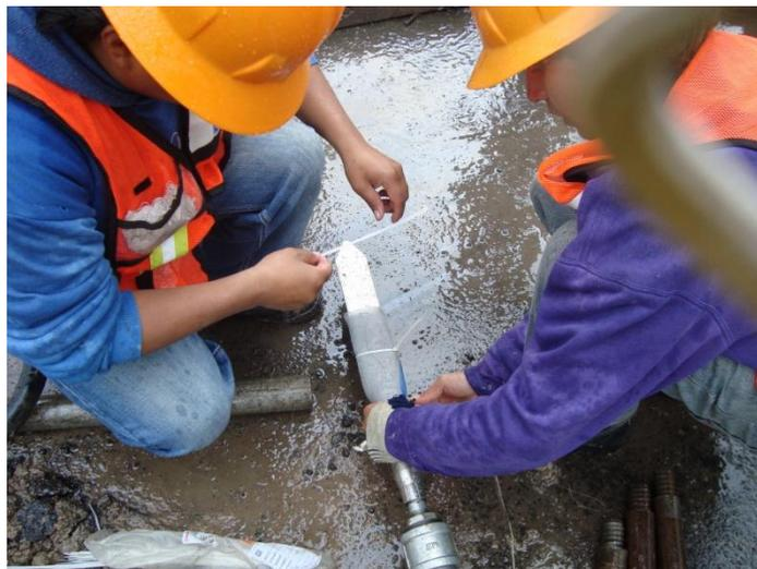
**Figura 82.** Filtro de geomalla en celda porosa.
