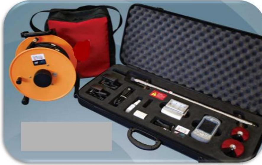
**Figura 24.** Vista de un equipo para medir Inclinómetros.
