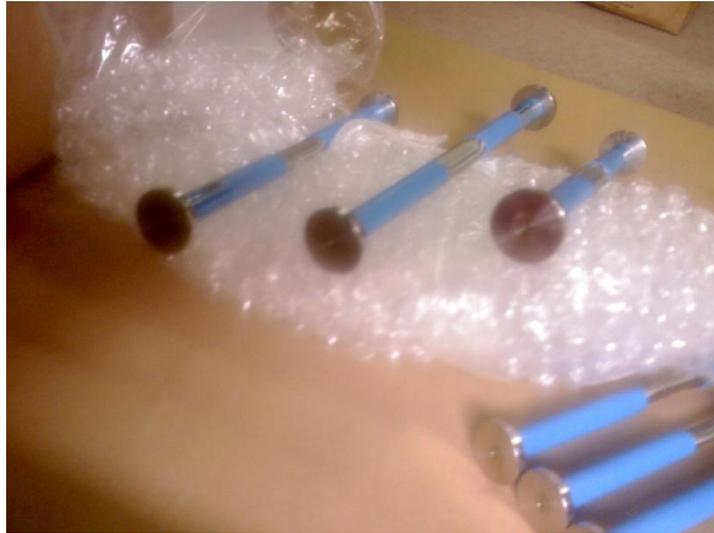
**Figura 46.** Deformímetros de concreto.
