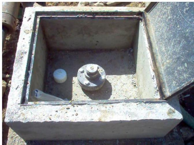
**Figura 69.** Registro de Extensómetro de barras.
