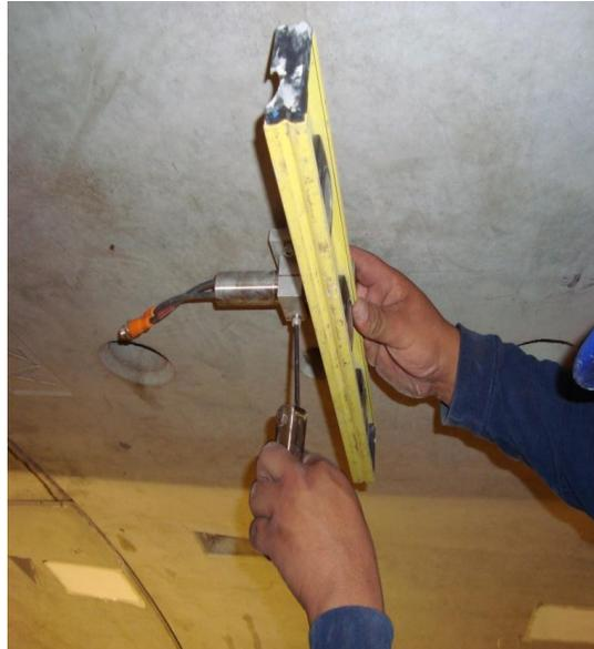
**Figura 55.** Nivelación de clinómetro uniaxial.
