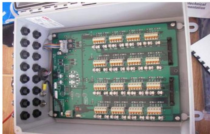
**Figura 37.** Parte interna del Multiplexor.
