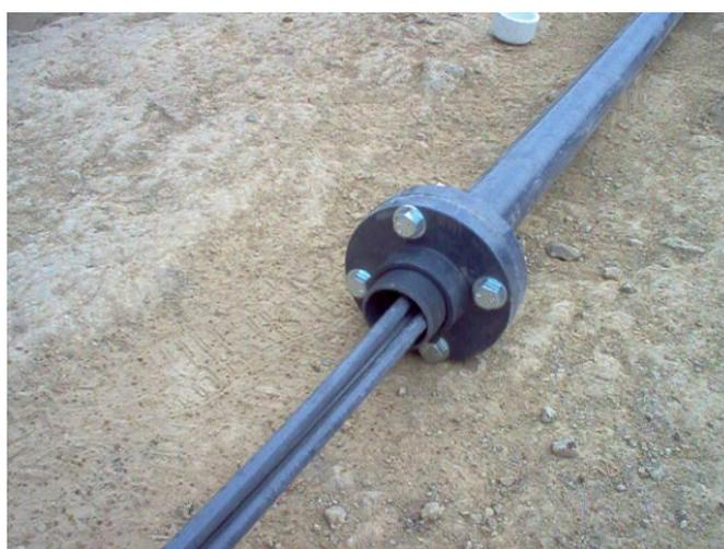
**Figura 67.** Tubo de protección unido al cabezal del extensómetro.
