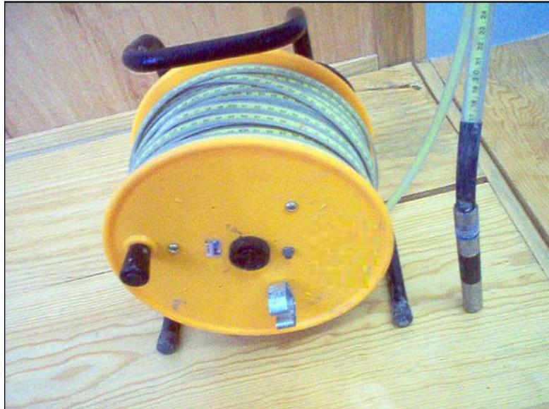
**Figura 101.** Vista de sonda magnética.
