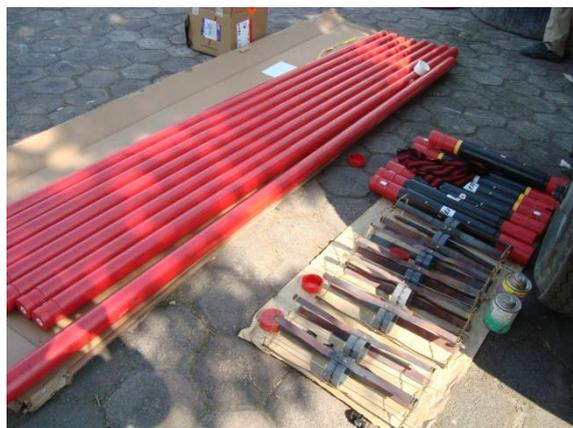
**Figura 70.** Elementos que conforman un Extensómetro Magnético.
