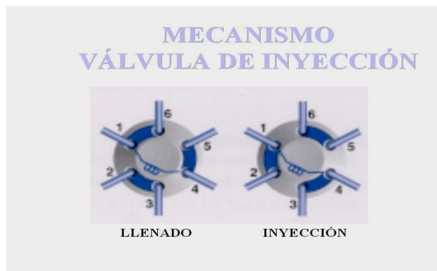
Figura 9. Mecanismo de acción de la válvula de inyección en sus dos posiciones de llenado e inyección.
