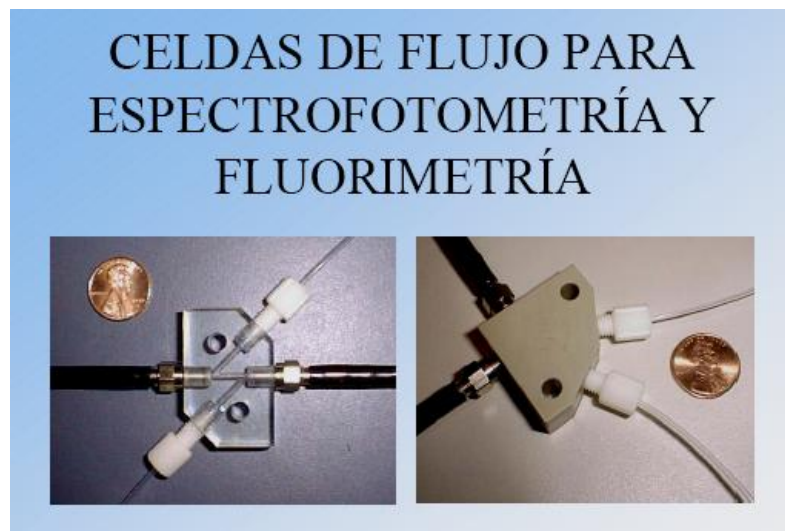
Figura 12. Celda de Peek (Zona de detección).
