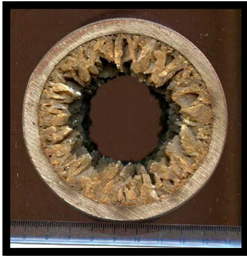
Fig 3.9 Incrustación de Bario en tubería 18
