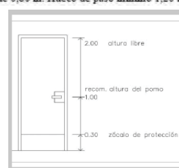
Doble puerta donde una de las hojas será como mínimo de 0,80 m. Hueco de paso mínimo 1,20 m
