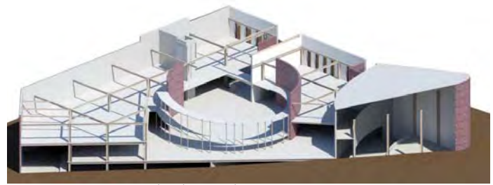
150. Estructura principal: columnas de acero y losa lámina corrugada
