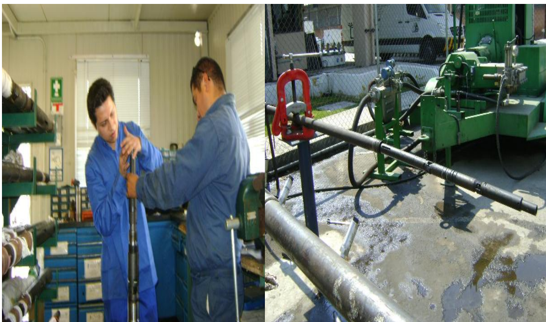
Fig. 4.17. Introducción de la herramienta en la tubería de 2 7/8”.
