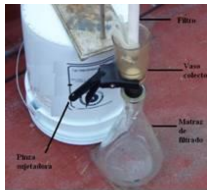
Figura 4-11. Sistema recolector de filtrados (equipo Millipore)
