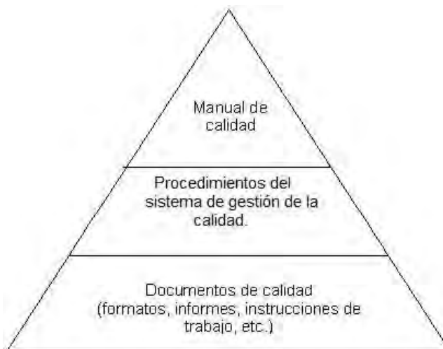
Figura 2. Jerarquía típica de la documentación de un sistema de gestión de la calidad
