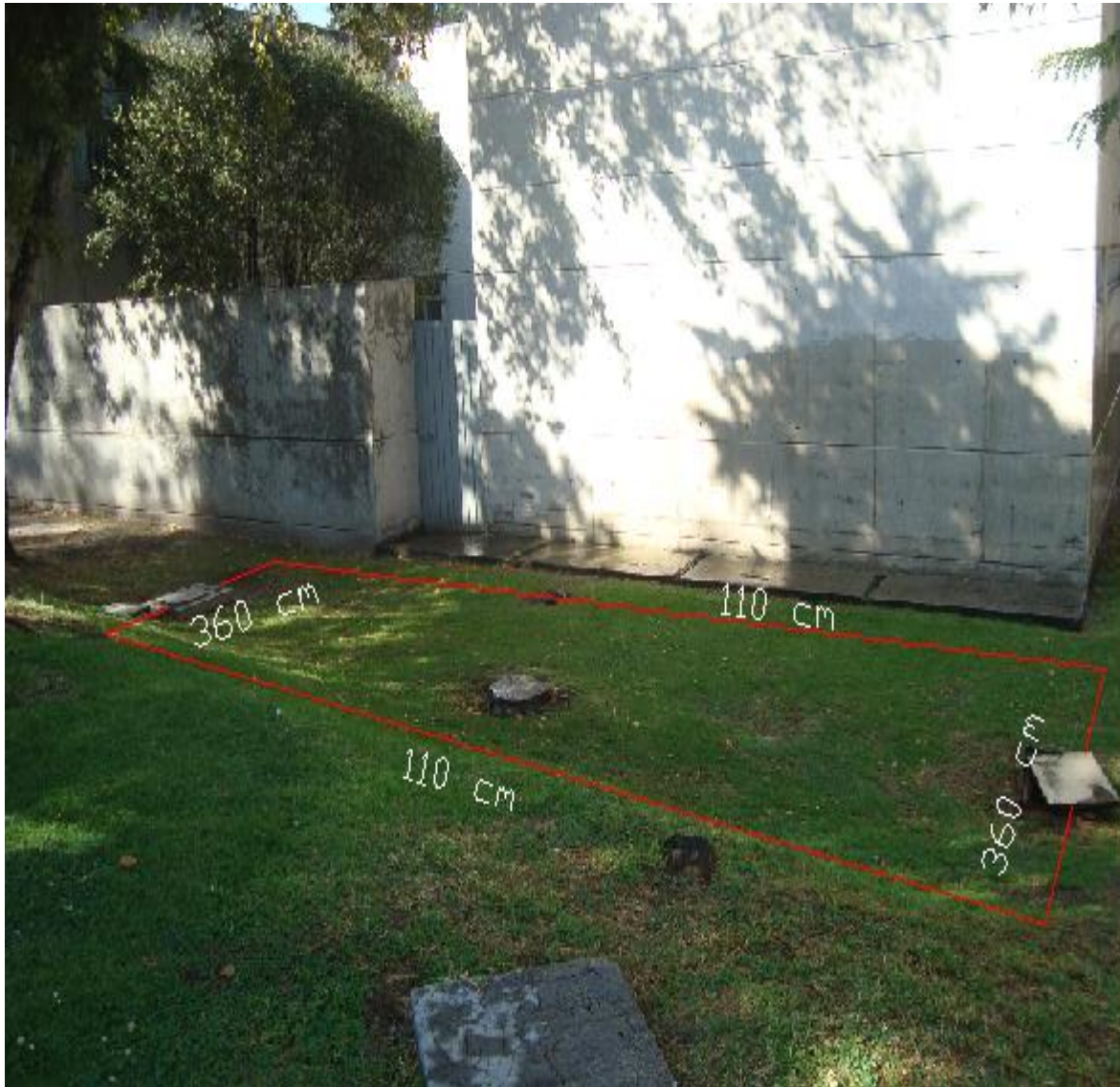
Figura 8.7. Vista aproximada de las dimensiones de la celda de humedal. Las dimensiones necesarias para la remoción de DBO se proponen e 40.00 \text{ m}^2 (en el lecho), con una relación largo: ancho de 3:1
