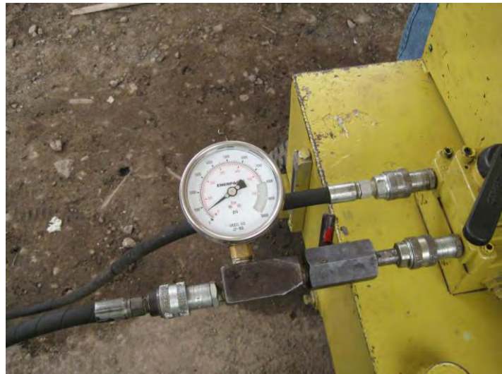
Sistema de gatos y celdas de carga
