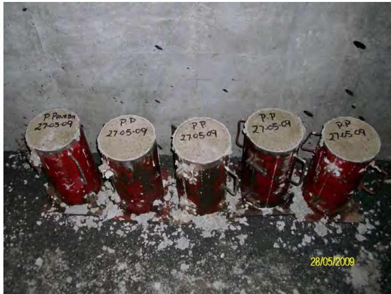
Se tomaron 6 probetas del concreto vaciado para su posterior ensaye.
