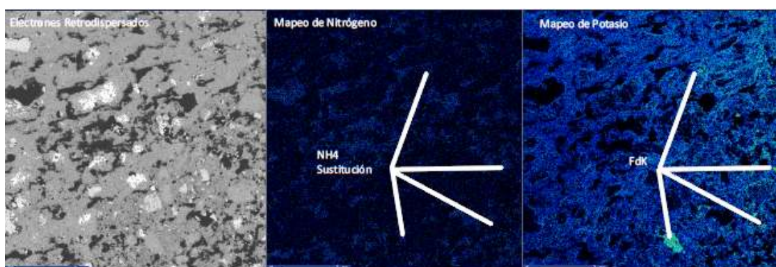
Fig. 20 Imagen SEM de electrones retrodispersados, los puntos con menor brillo tienen una composición con menor número atómico en promedio (Izquierda). Mapeo de nitrógeno (centro), la concentración de puntos coinciden con la resina de la lámina delgada sin embargo se observan algunos puntos de N dentro de los feldespatos denotados por el mapeo en potasio (derecha). La escala gráfica corresponde a 2 \mu\text{m} . Muestra EAC-1-N2 (300 m).
