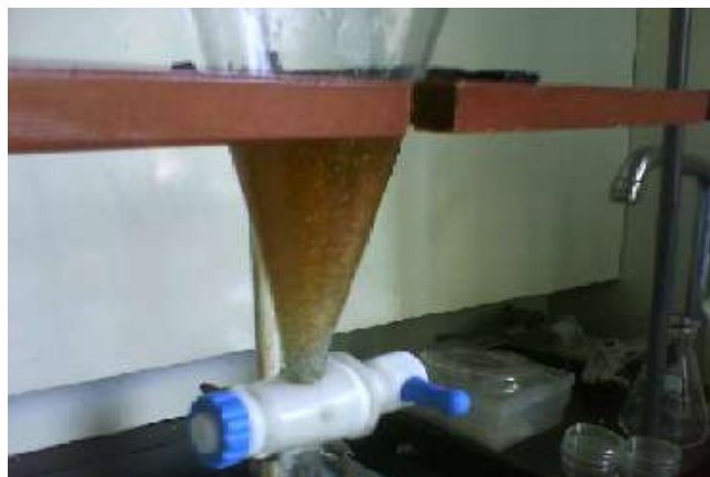
Fig. 5. Separación por densidades, a través de la decantación en un líquido denso. La buddingtonita flota mientras que las plagioclasas y los feldespatos potásicos se hunden lentamente en el embudo.
