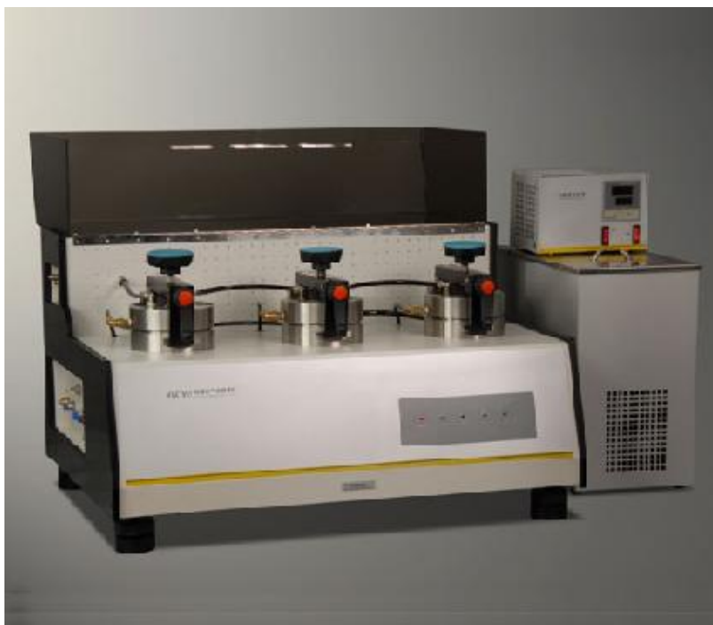
Figura 13. Celda manométrica utilizada en la determinación de permeabilidad al oxígeno.
