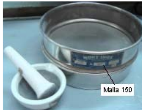
Figura 5.1: Equipo necesario para triturar (mortero) y tamizar (malla 150).
