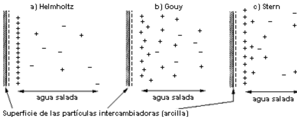
Figura 3.10: Modelos esquemáticos que representan la teoría de la doble capa eléctrica según: a) Helmholtz, b) Gouy y c) Stern.
