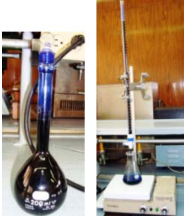
Figura 5.5: Solución de azul de metileno (izq.). Equipo utilizado para la titulación de la suspensión de arcilla con solución de azul de metileno (der.).
