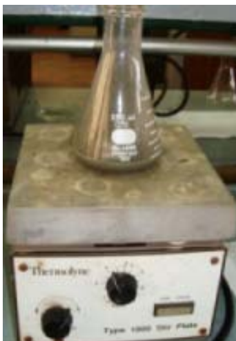
Figura 5.4: Matraz que contiene la suspensión de arcilla antes de la titulación con azul de metileno.
