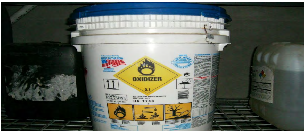
Foto 18. Cloro alimenticio requiere de un manejo adecuado por las propiedades químicas que desarrolla al contacto con la piel y con el agua, altas concentraciones pueden dañar incluso las tuberías hidráulicas de la planta.
