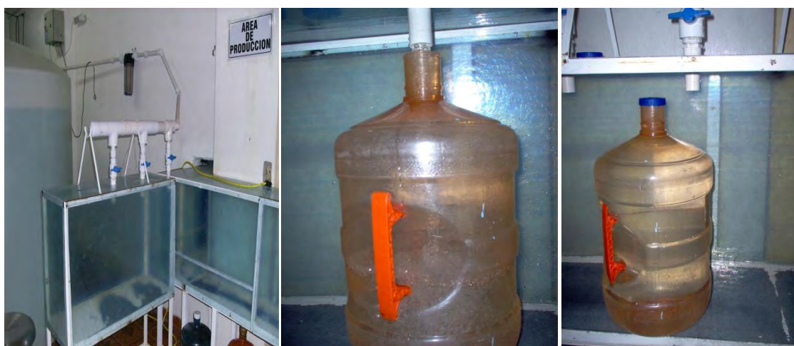
Foto 32. Llenado y sellado de garrafones.
