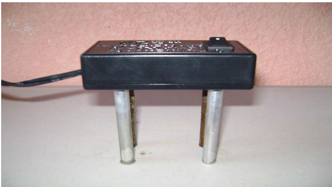
Fotografía 33. Mesa de hidrólisis, tecnología que descompone las sales disueltas en el agua y que a simple vista no son detectables por el ojo humano.
