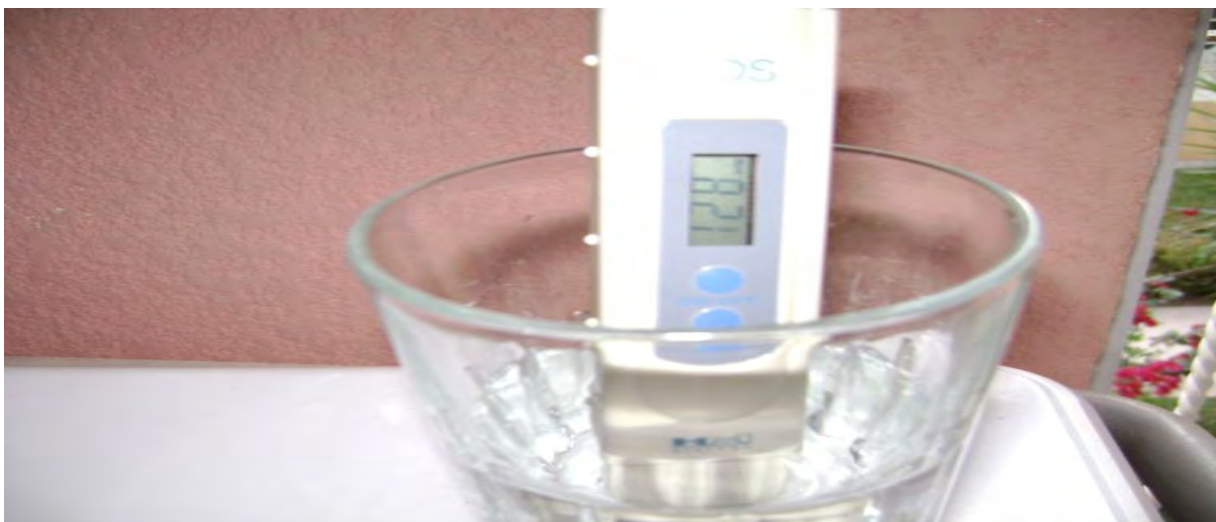
Fotografía 35. (Caso1). Medidor de sólidos disueltos en el agua.
