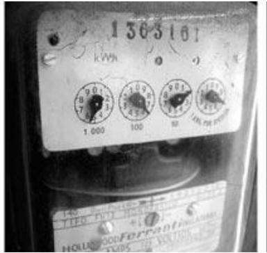
Figura 3-16 Medidor electromecánico de consumo eléctrico
