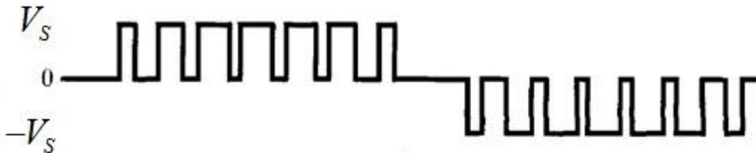
Figura 3-12 Forma de onda de salida para un inversor de puente completo de conmutación unipolar
