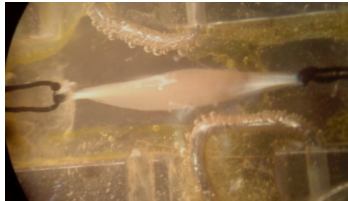
Figura 3-5: Músculo aislado y sujetado en la cámara de estimulación.
