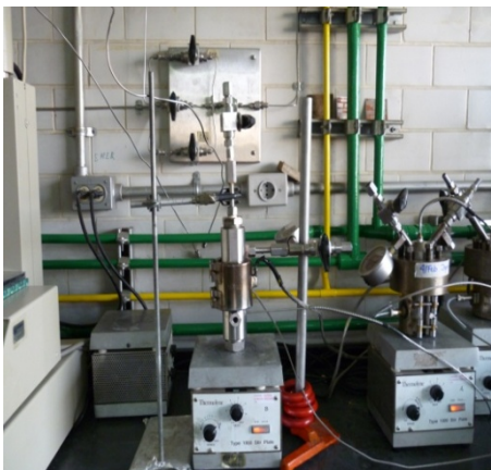
Figura 15. Reactor con mirillas.
