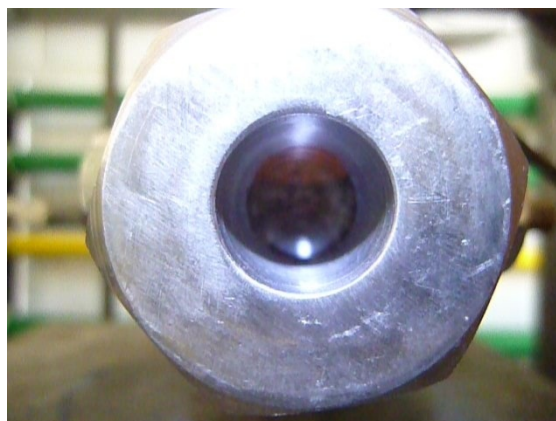
Figura 16. Vista lateral de reactor de mirillas cargado con diésteres, enzima y TFE
