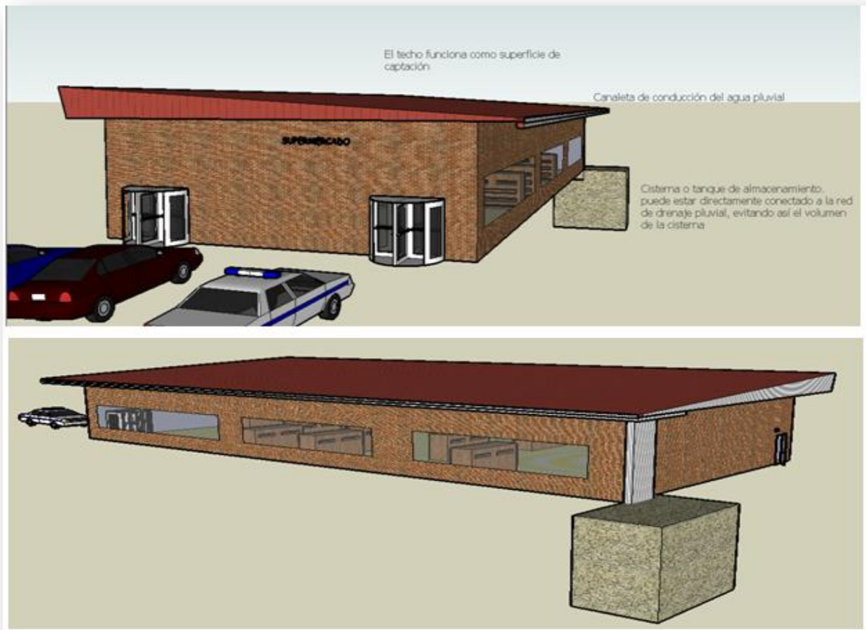
Ilustración 20 Muestra los componentes básicos, de un sistema de captación, para techos, y azoteas. 92
