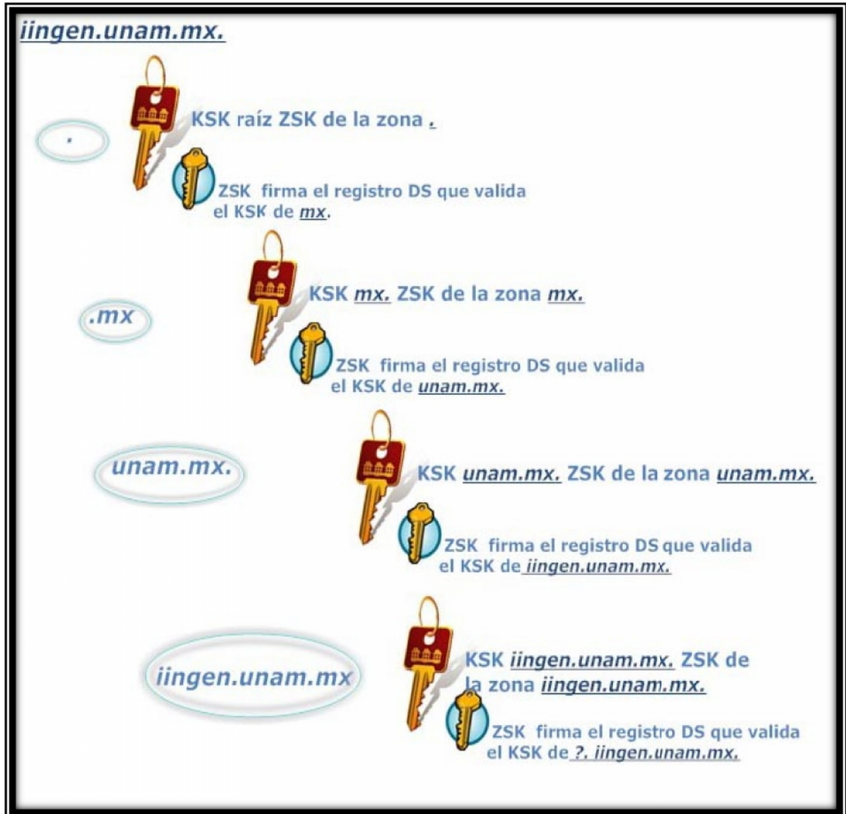
Figura 3.17 Estructura de firmas KSK y ZSK
