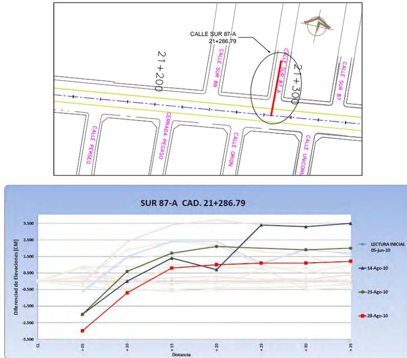
Figura 4.8 Desplazamientos verticales de la superficie del terreno medidos en la dirección transversal al eje del túnel en el cadenamiento 21+287 km
