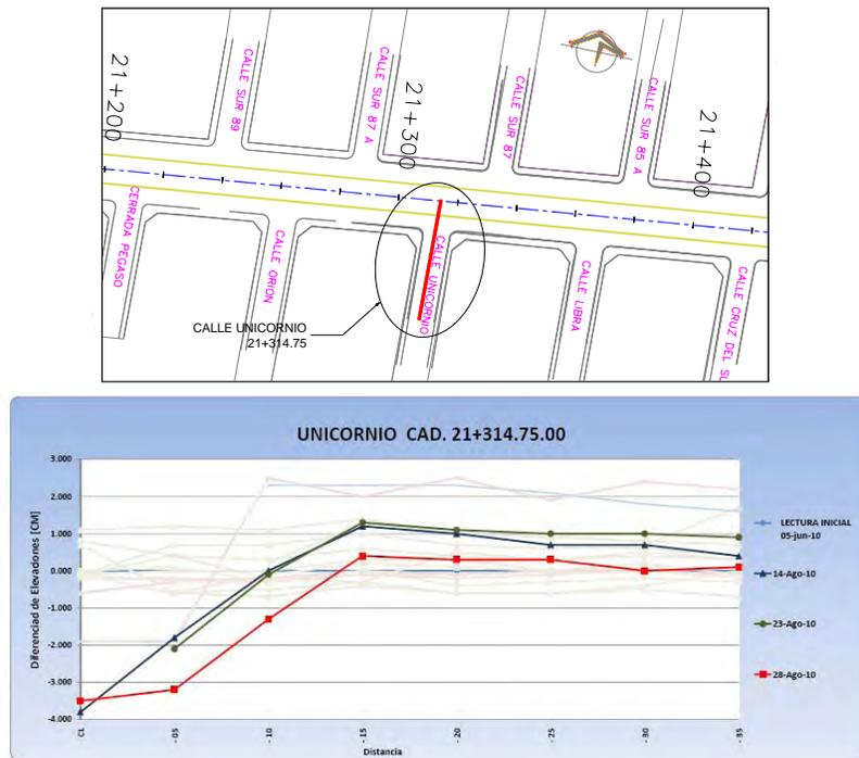
Figura 4.10 Desplazamientos verticales de la superficie del terreno medidos en la dirección transversal al eje del túnel en el cadenamamiento 21+315 km
