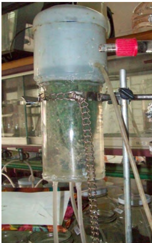
Figura 3.1 Reactor biológico de lecho fijo.
