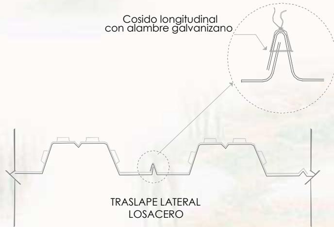
Detalles de unión de losacero .
