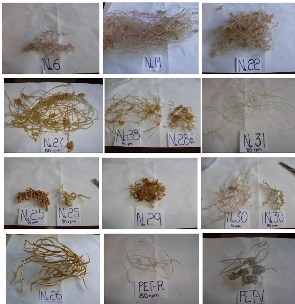
**Fig.5.5: Imágenes de los diferentes hilos obtenidos en las cinco pruebas de extrusión. Se presentan hilos con degradación parcial (Números: 6, 14, 22, 27, 28 y 31) y degradación total (Números: 25, 26, 29, 30 y 32), PET R y PET virgen.**
