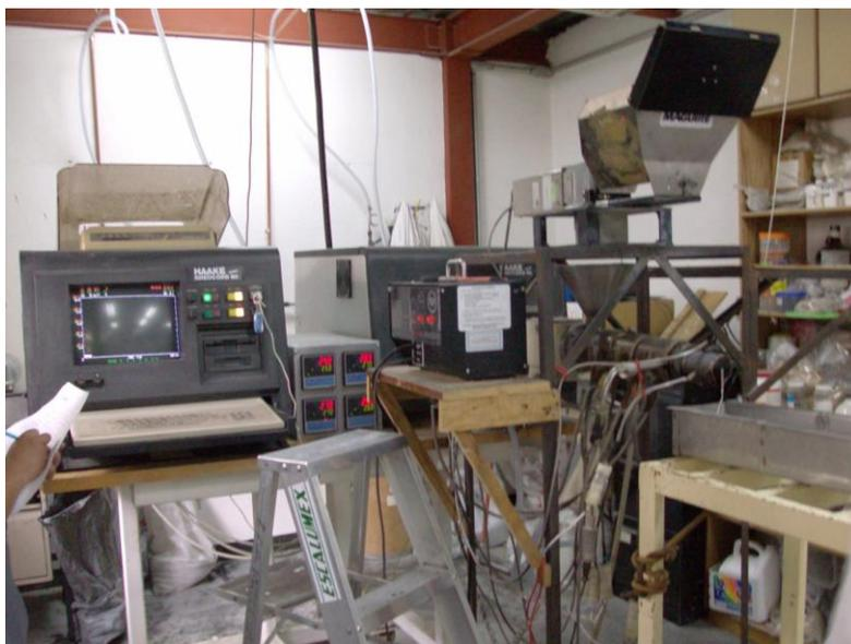
**Fig. 3.4 Extrusor de doble husillo (IIM). A la izquierda se ve la pantalla donde se grafica el torque a lo largo de la extrusión. A su derecha se observa el módulo que indica las temperaturas en rojo de las cuatro zonas del cañón. Más a la derecha se observa arriba la tolva, abajo el cañón y la salida que forma hilos que se reciben en la tina de agua.**
