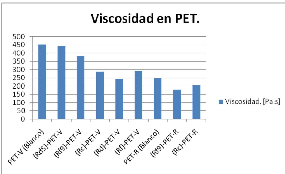
**Fig.6.4 Disminución en la viscosidad del PET, debido a la presencia de un catalizador en las diferentes síntesis del aditivo. (Ver Tabla 6.2). Datos obtenidos del plastómetro bajo las condiciones de la norma ASTM D1238.**
