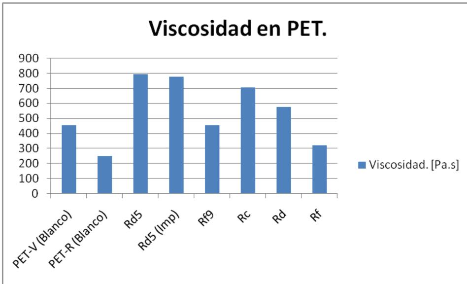
**Fig.6.3 Incremento de la viscosidad en PET, debido al efecto de las diversas síntesis del aditivo, sin la presencia de catalizador. Correspondiente a los datos de la Tabla 6.3 obtenidos del plastómetro bajo las condiciones de la norma ASTM D1238.**
