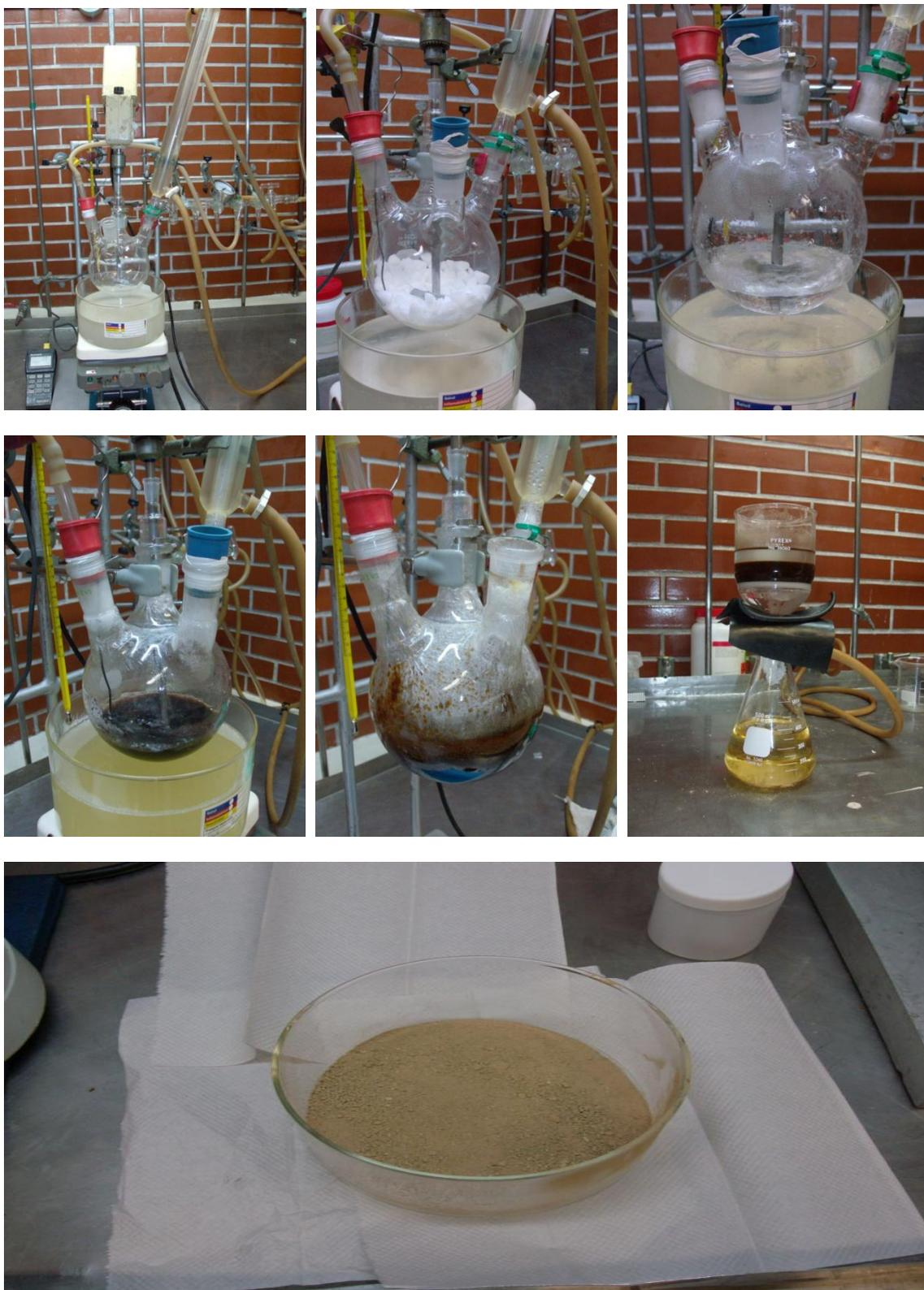
**Fig.3.2 Esquematzación de la reacción de homopolimerización en estado fundido.**
