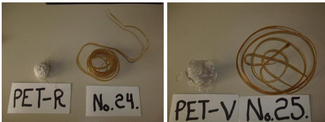
**Fig.6.6 Muestras de PET con aditivo obtenidas del plastómetro y su comparación con PET-R y PET.**
