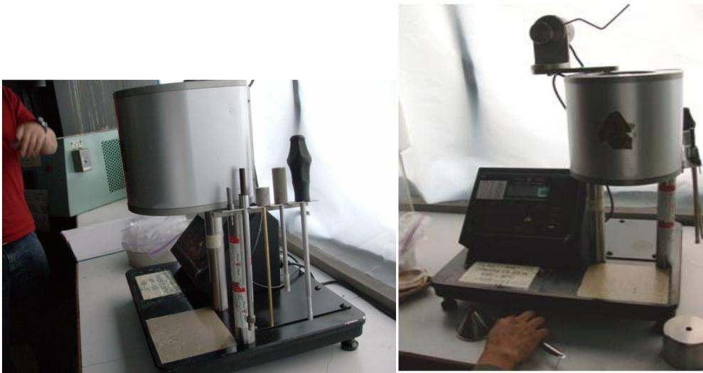
**Fig. 3.6 Plastómetro extrusor para la determinación de la viscosidad e índice de fluidez.**
