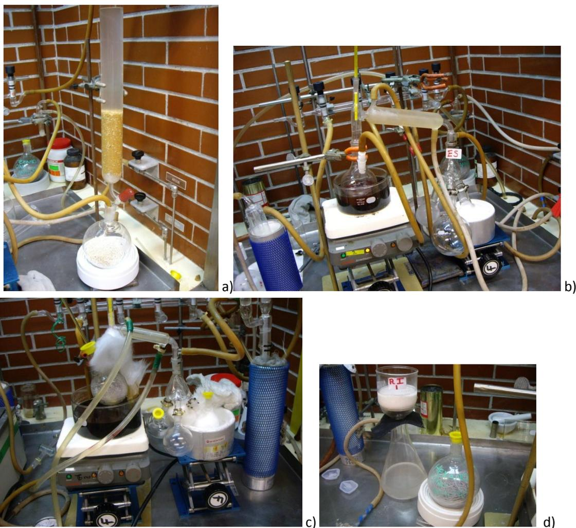
**Fig.3.1 Algunas técnicas de purificación de reactivos. a) Columna con malla molecular para secado dinámico, b) Destilación de estireno a presión reducida, c) Destilación de MAH a presión reducida, d) Hexano con sodio metálico en hilos.**
