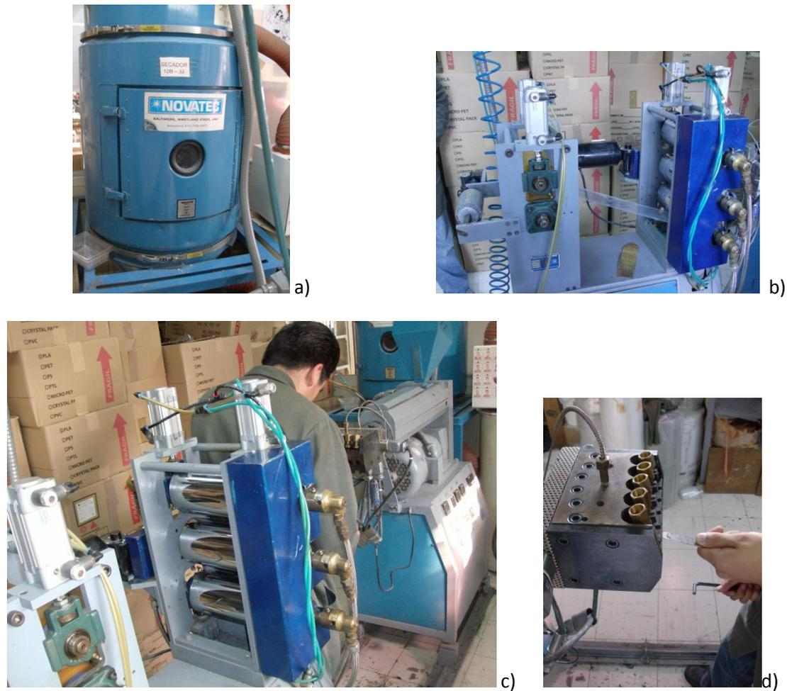
**Fig.3.5 a) Secador de PET, b) Jalador con tres rodillos para película, c) extrusor monohusillo y d) dado plano del extrusor.**
