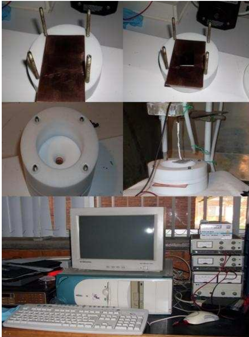
Figura 2.7: Equipo experimental utilizado para la fabricación de multicapas de p-Si. En la parte superior se muestra la celda de teflón en la que se realiza el ataque electroquímico del c-Si. En la parte inferior se observan las fuentes de corriente usadas para la fabricación de multicapas de p-Si.
