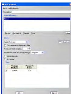
Figura 6.1 Comando utilizado en ABAQUS para ingresar los valores de las constantes elásticas del material.
