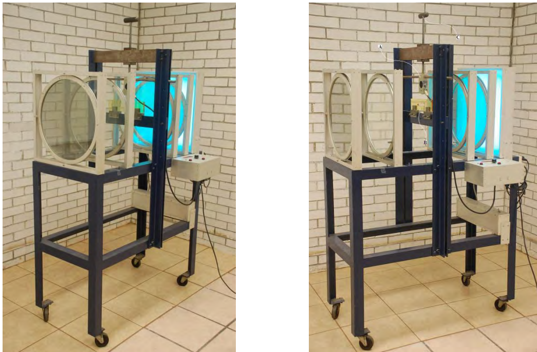
Figura 3.1 Arreglo experimental con las siguientes componentes: A) Celda de carga, instrumentada en la parte central por medio de tres strain gages; B) Placa modelo de resina epóxica; C) Tornillo sinfín para aplicar la carga a compresión.
