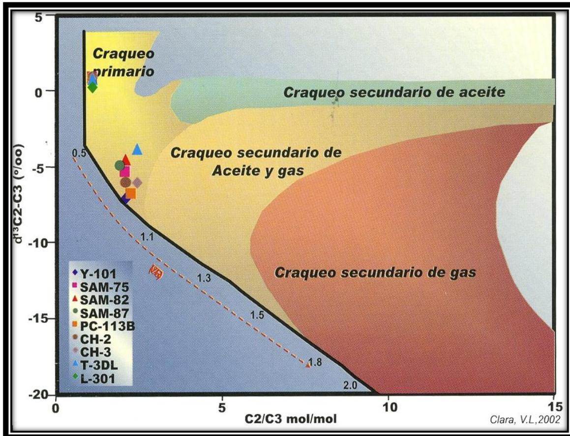
Figura 3.18 Esquema de eventos genéticos de la degradación térmica de la materia orgánica y de los gases de la cuenca. <sup>40</sup>
