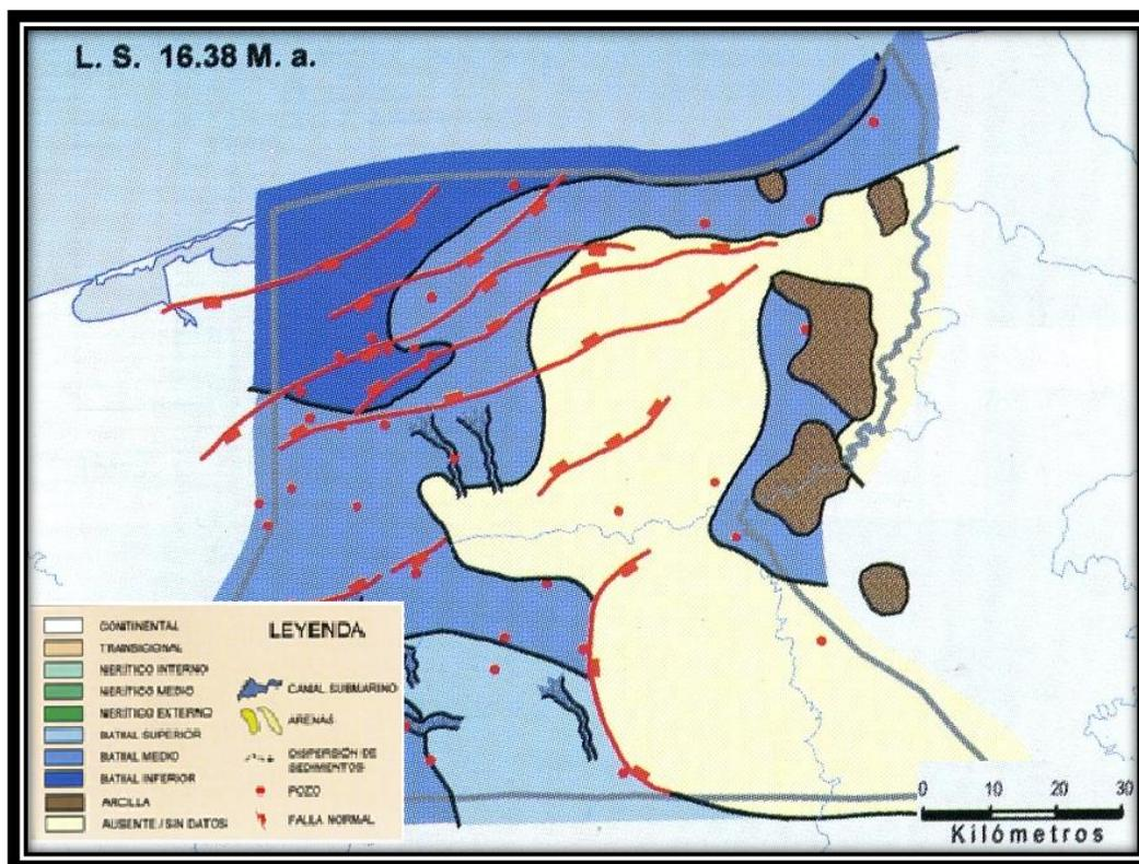
Figura 2.13 Esquema que muestra la distribución de lutitas fosilíferas en ambientes de talud medio-inferior. Inicia el depósito de limos y arenas muy finas en complejos progradantes.<sup>53</sup>
