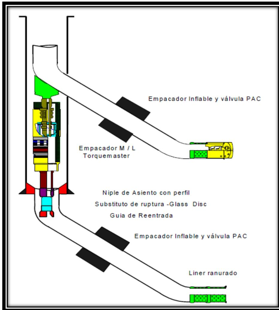
Figura 4.24 Perforación del lateral superior.<sup>34</sup>
