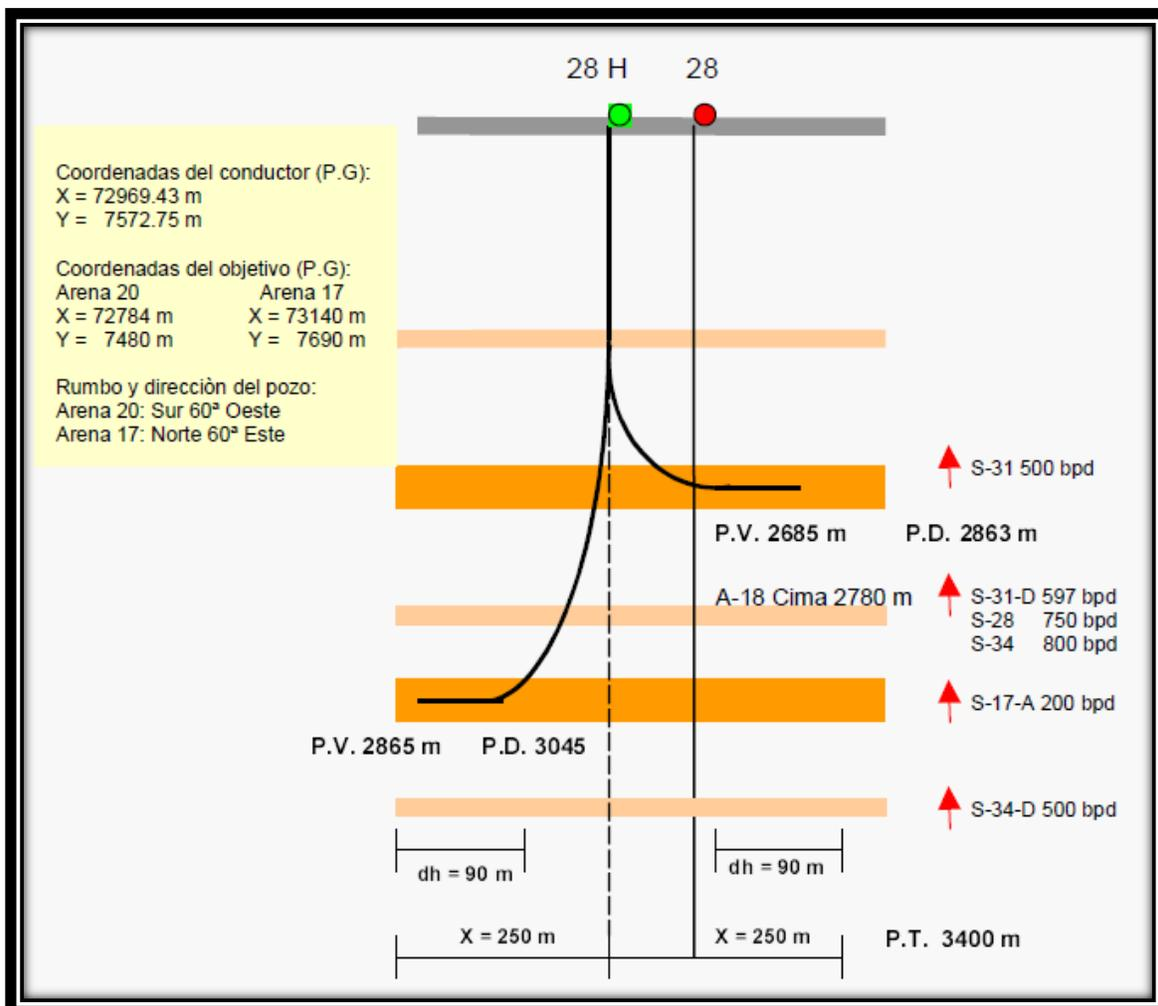
Figura 4.20 Objetivo de la perforación pozo Santuario 28 H.<sup>30</sup><sup>29</sup> Modificado de Un siglo de la perforación en México, UPMP.<sup>30</sup> Un siglo de la perforación en México, UPMP.
