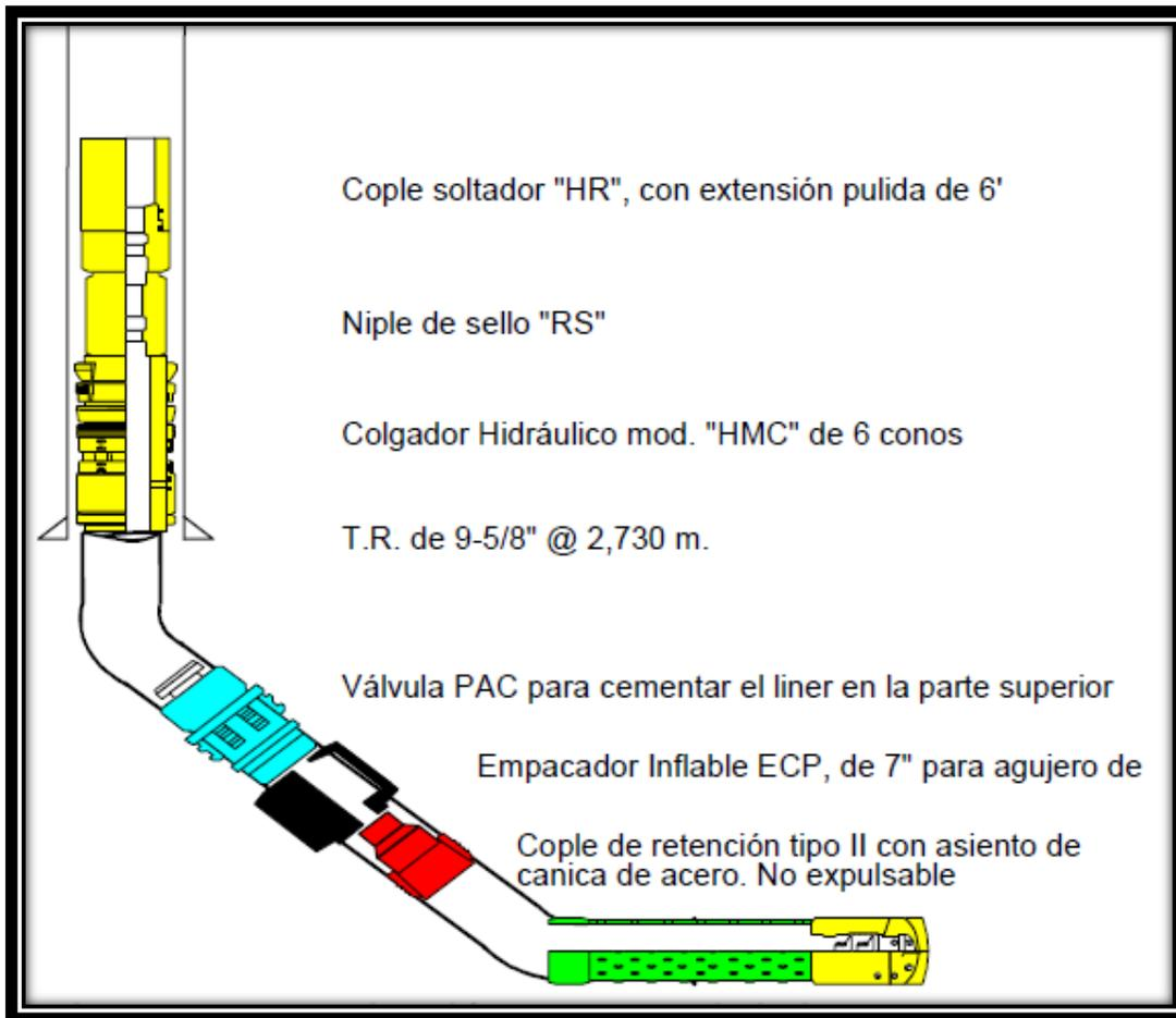
Figura 4.22 Terminación del lateral inferior del Pozo Santuario 28 H.<sup>32</sup>
