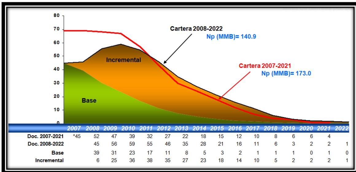
Figura 5.10 Comparación del horizonte de producción de aceite de los programas de operación.<sup>11</sup>
