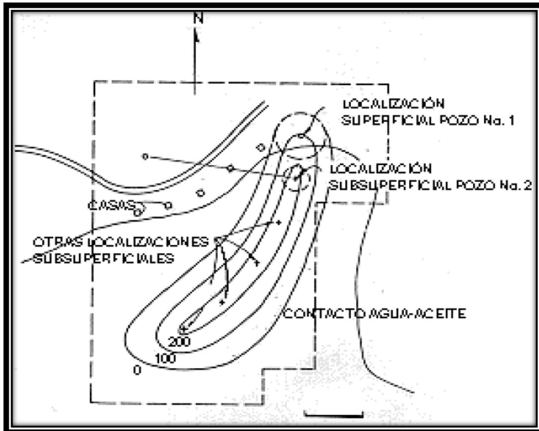
Figura 4.2 Vista en planta de un yacimiento típico de aceite y gas debajo de un lago, mostrando cómo se pueden utilizar los pozos direccionales para desarrollar un campo.<sup>6</sup>
