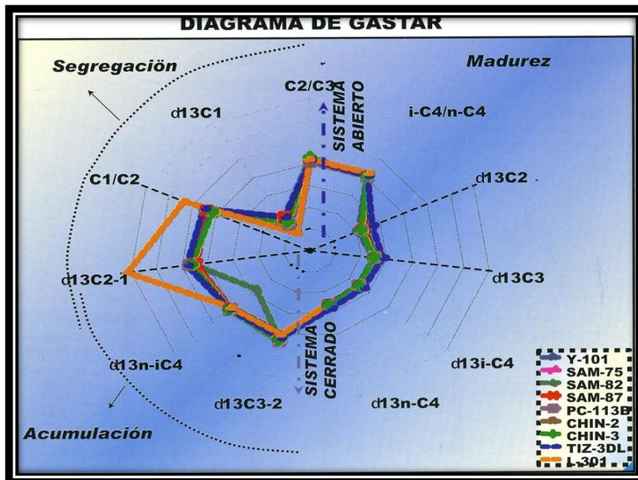
Figura 3.20 El comportamiento de los gases indica que provienen de una misma roca generadora.<sup>42</sup>
