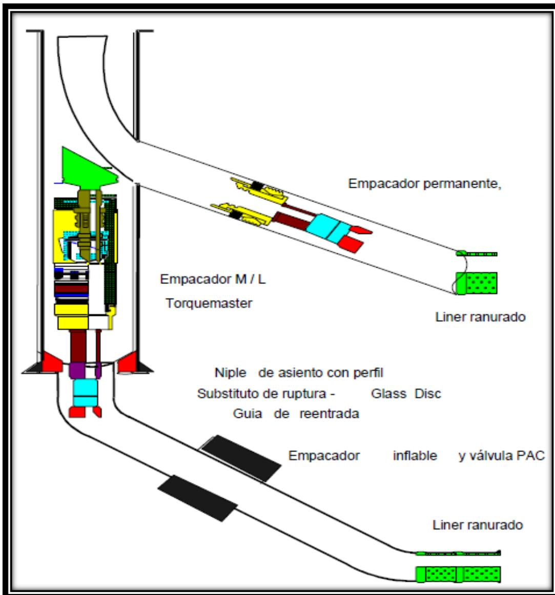
Figura 4.25 Terminación del lateral superior.<sup>35</sup>
