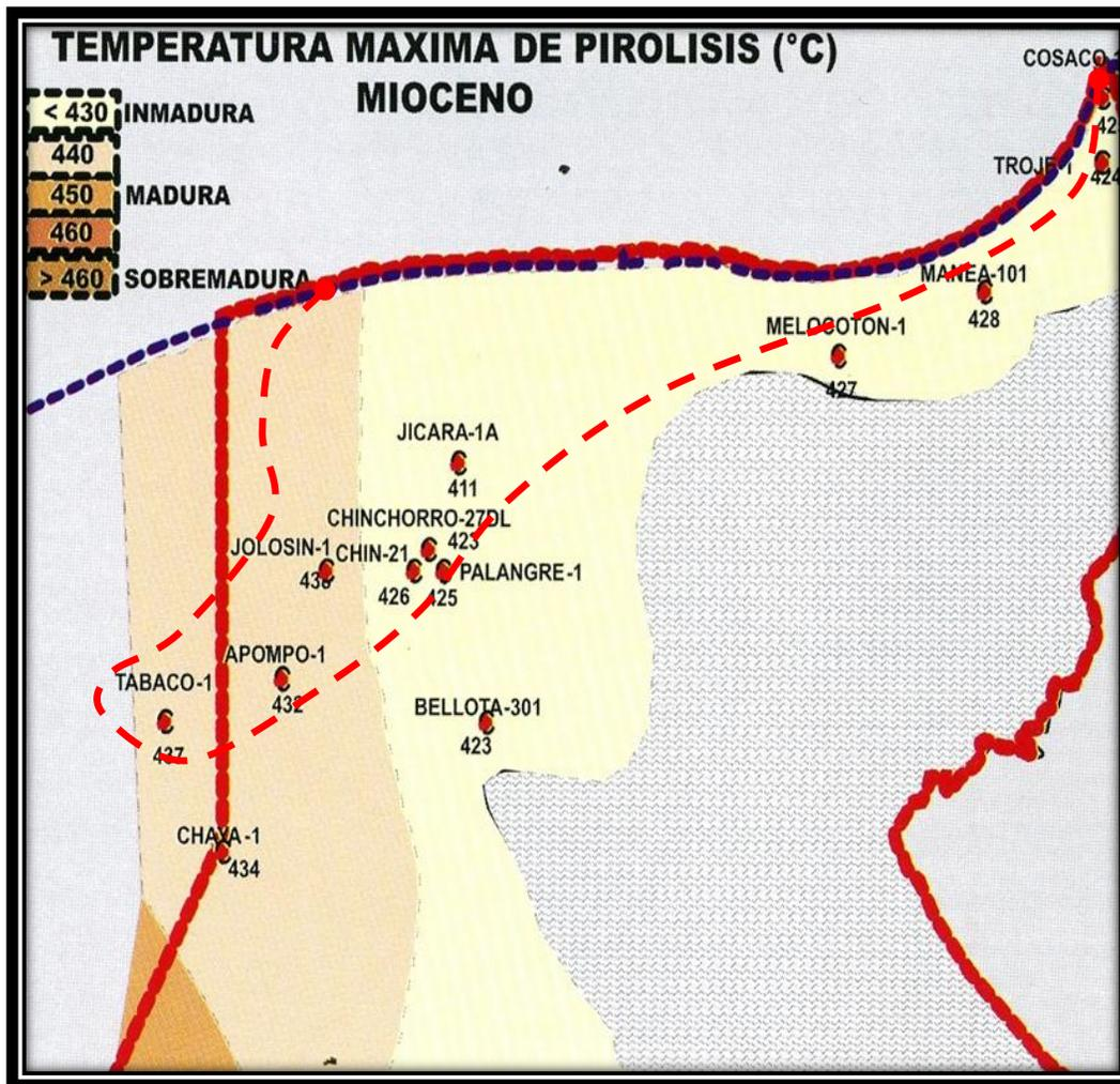
Figura 3.13 Distribución de la temperatura máxima ( $T_{\text{máx}}$ ) que afectaron las secuencias clásticas del Mioceno inferior.<sup>30</sup>
