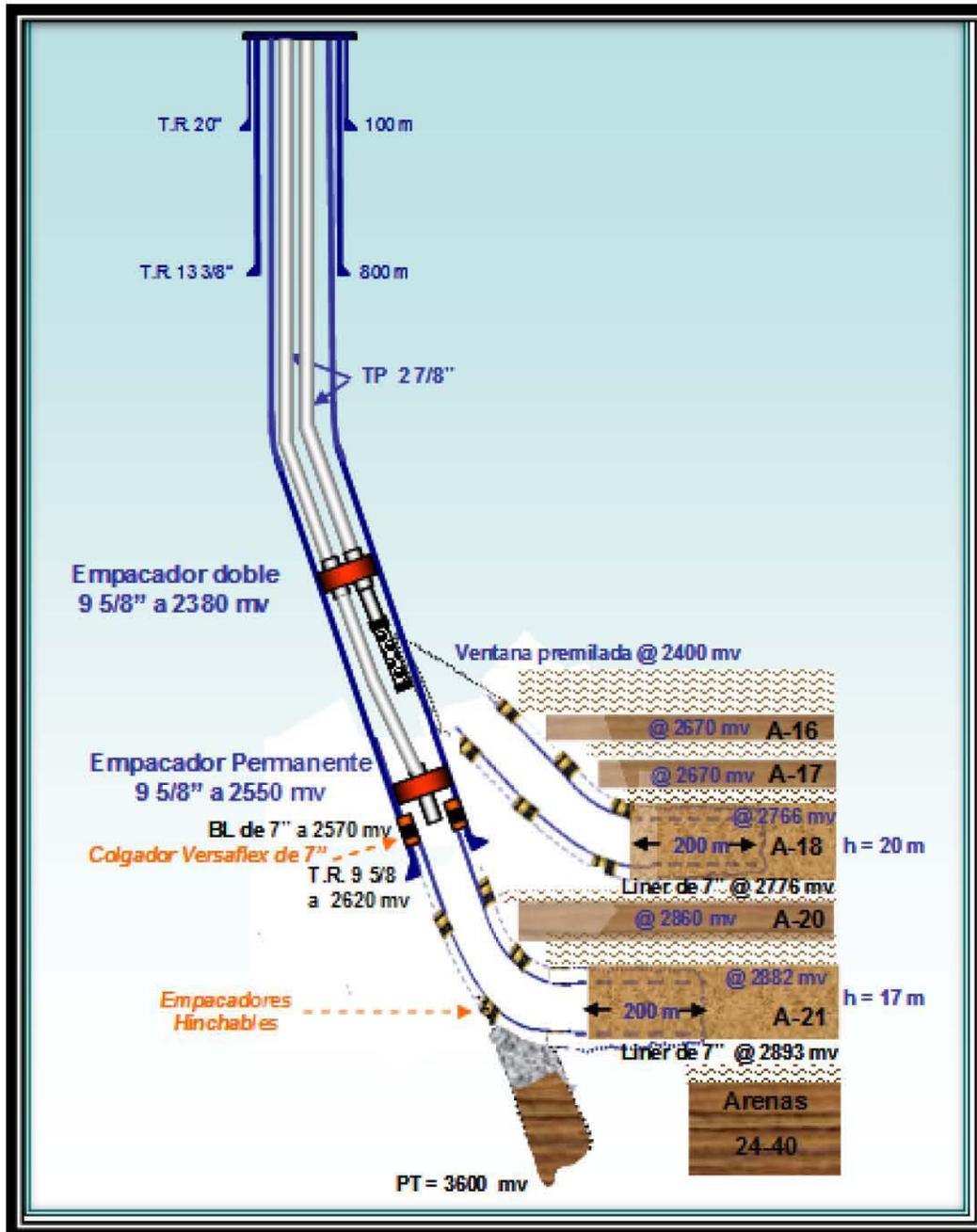
Figura 4.9 Estado mecánico propuesto Pozo Santuario 28 H.<sup>14</sup>
