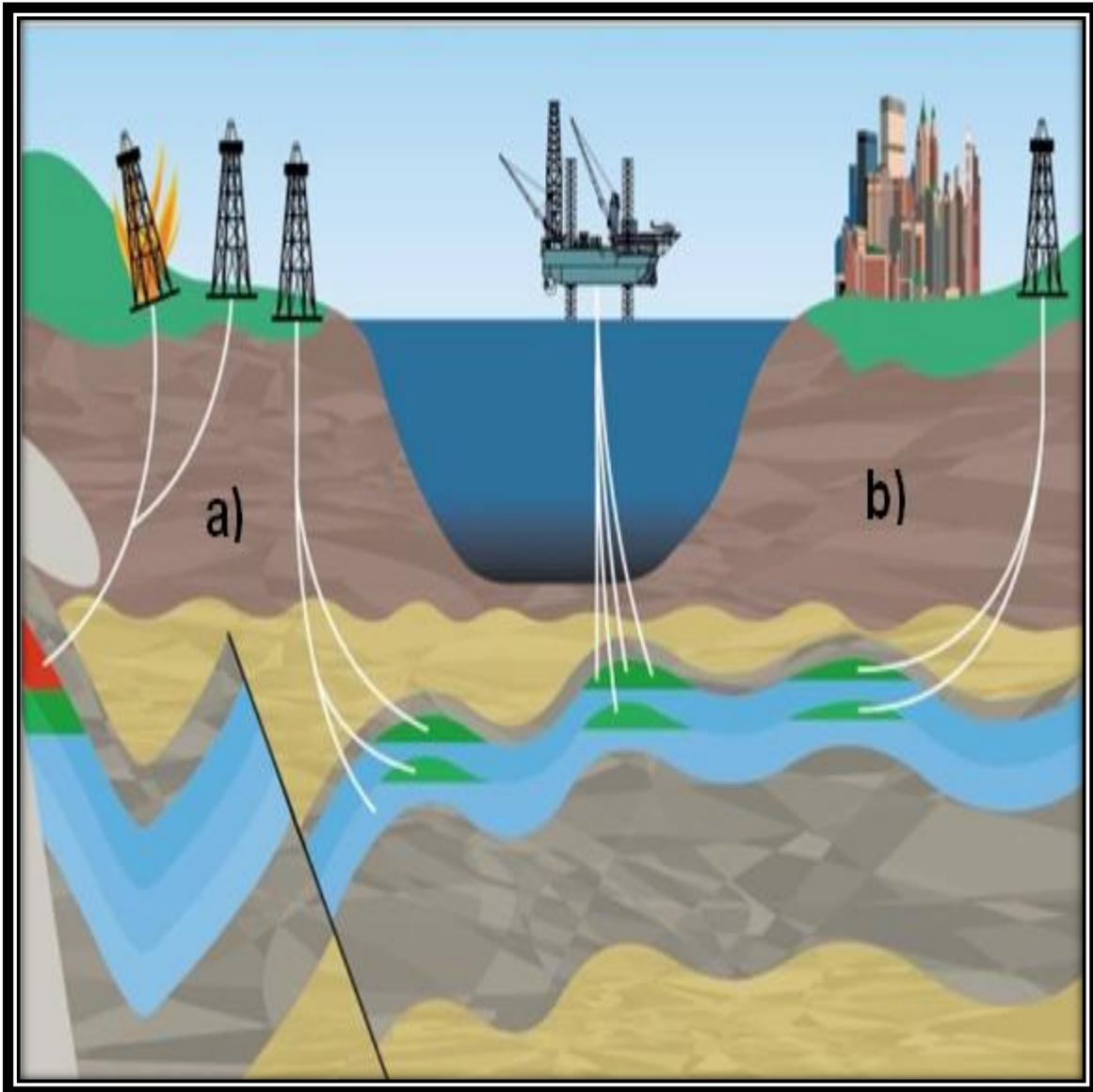
Figura 4.4 Perforación de pozos direccionales: a) el yacimiento se encuentra debajo de una obstrucción superficial grande; b) yacimiento localizado debajo de una ciudad.<sup>8</sup>
