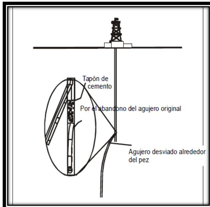
Figura 4.5 Aplicación de pozos direccionales en una obstrucción por pez.<sup>9</sup>
