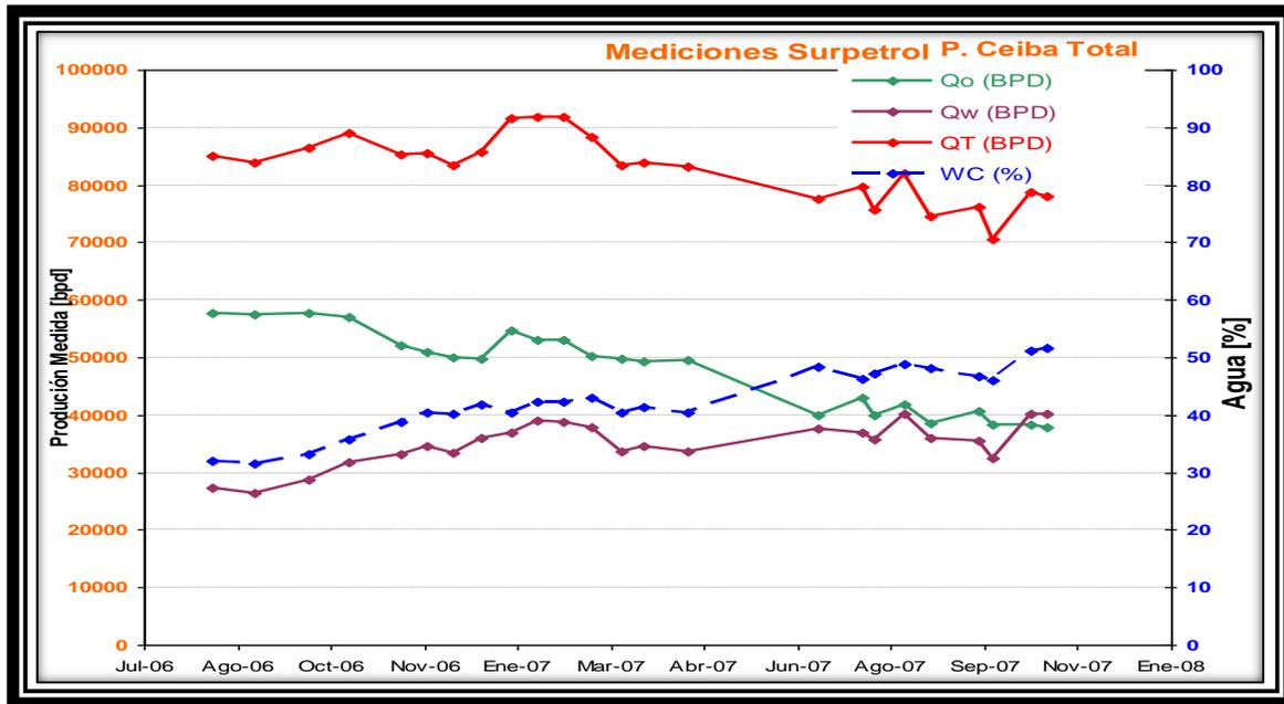
Figura 5.19 Comportamiento de la producción por mediciones.<sup>23</sup>
