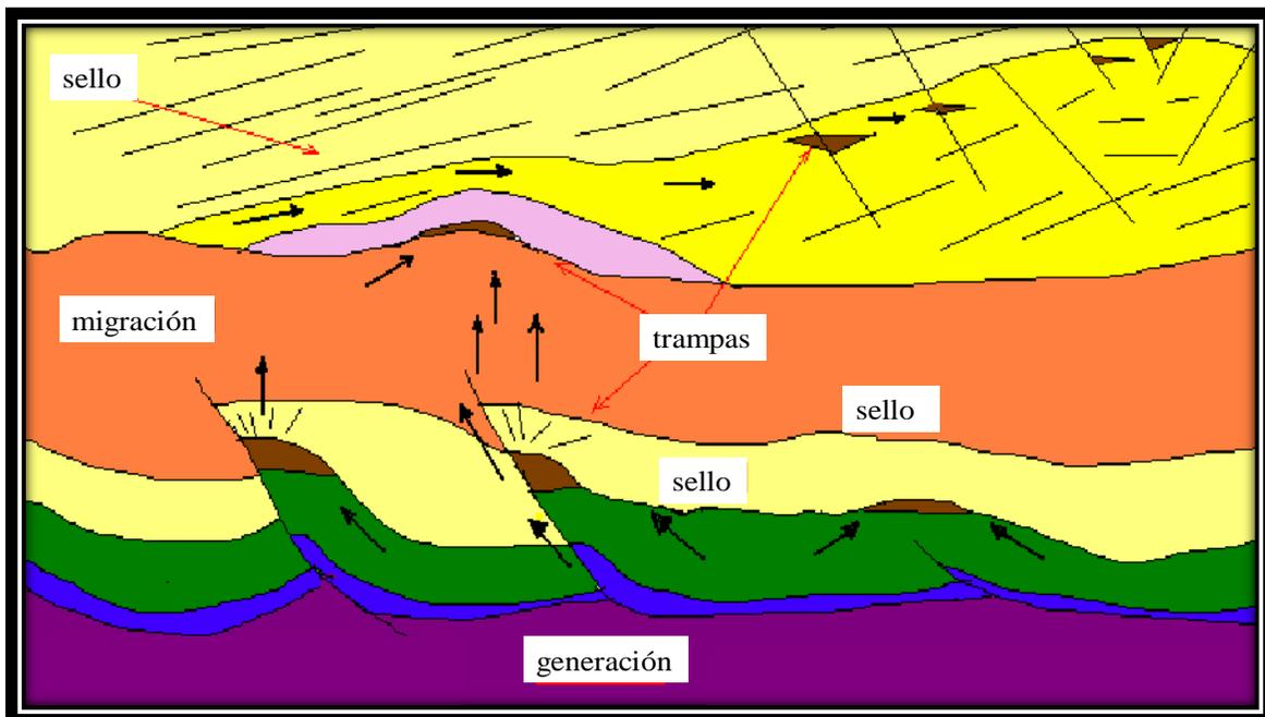
Figura 3.1 Componentes esenciales del sistema petrolero.<sup>2</sup>
