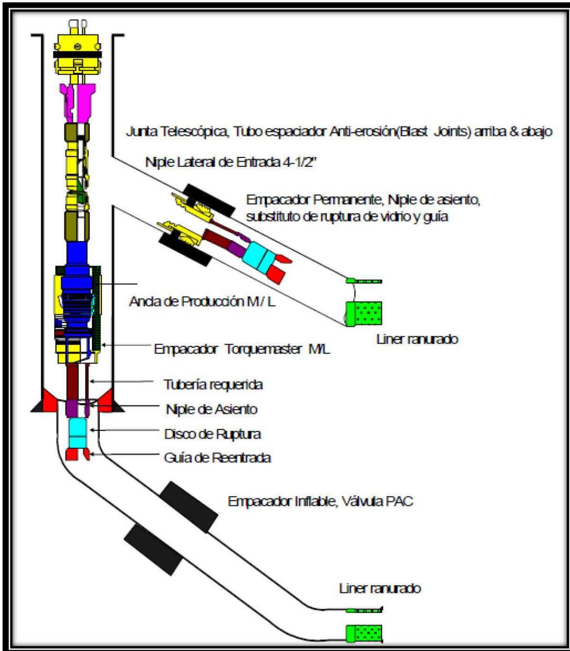
Figura 4.28 Corrida del equipo de terminación.<sup>37</sup>
