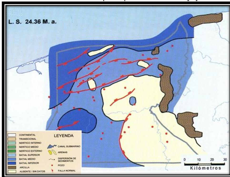
Figura 2.14 Mapa de distribución de las lutitas calcáreas de talud inferior inferior-medio, zonas erosionadas en la cima del Mioceno y brechas neógenas formadas por clastos calcáreos del Mioceno.<sup>54</sup>
