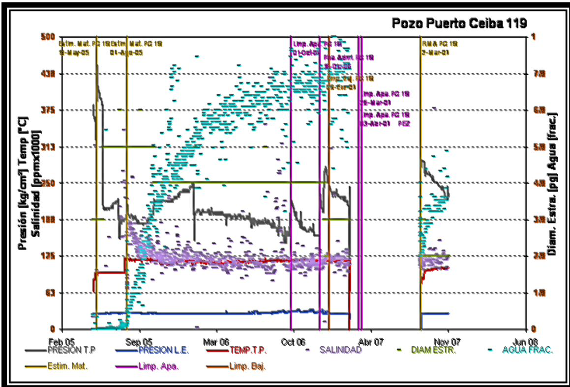
Figura 5.20 Análisis del cambio de diámetros de estrangulación en el pozo Puerto Ceiba 119.<sup>24</sup>
