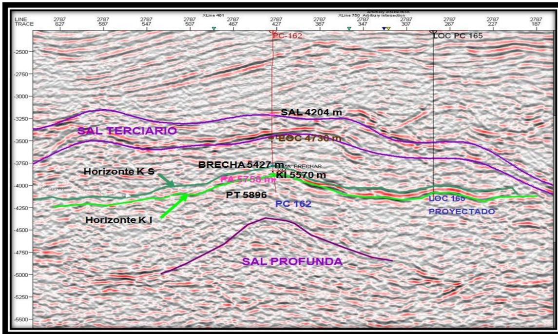
Figura 3.5 Sección sísmica pozo Puerto Ceiba 162, la sal profunda ejerce fuerza sobre los horizontes productores.<sup>17</sup>
