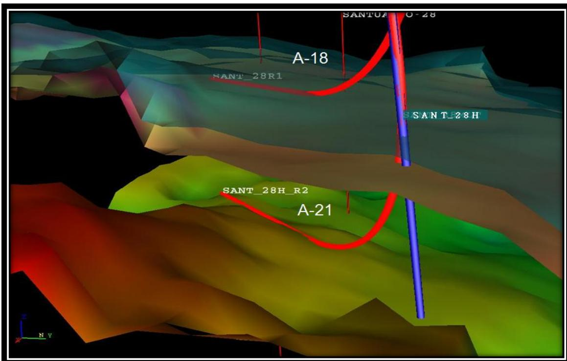
Figura 4.11 Vista en 3D Santuario 28 H (multilateral), dos ramas laterales a las arenas 18 y 21.<sup>16</sup>
