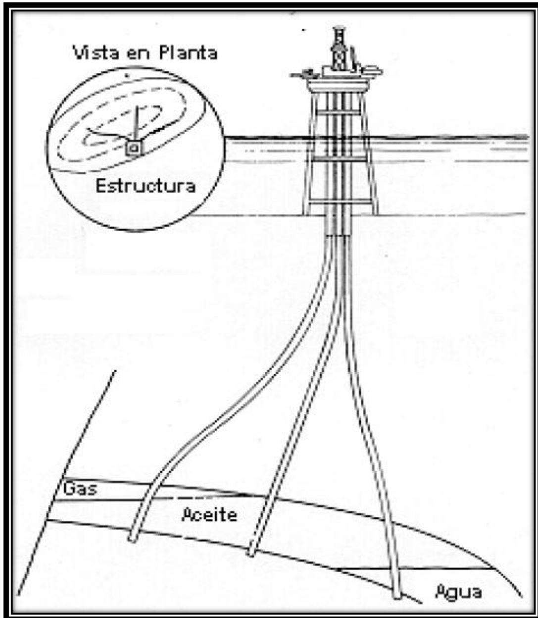
Figura 4.3 Plataforma marina con pozos direccionales.<sup>7</sup>
