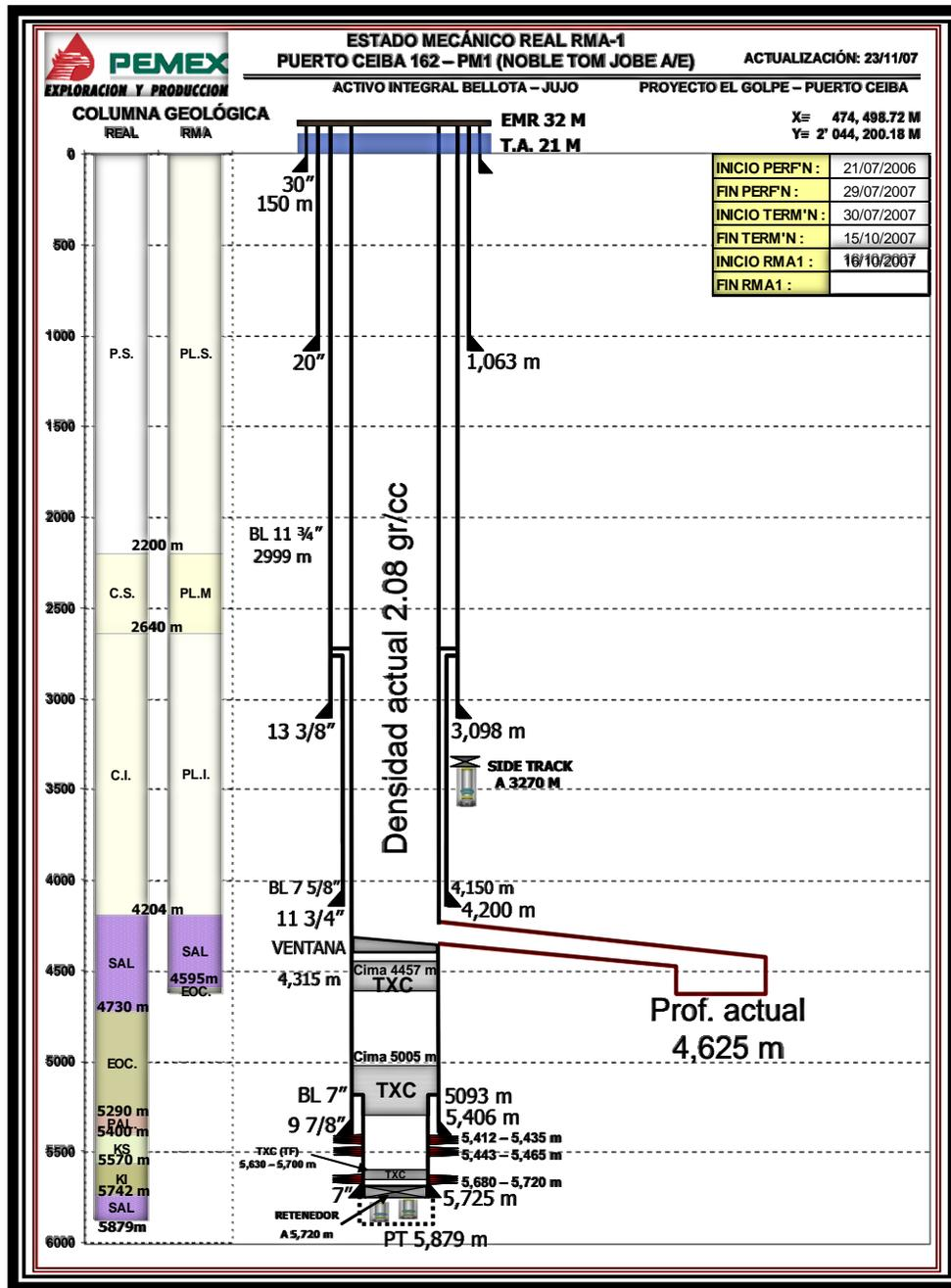
Figura 4.16 Estado mecánico del pozo Puerto Ceiba 162.<sup>23</sup>
