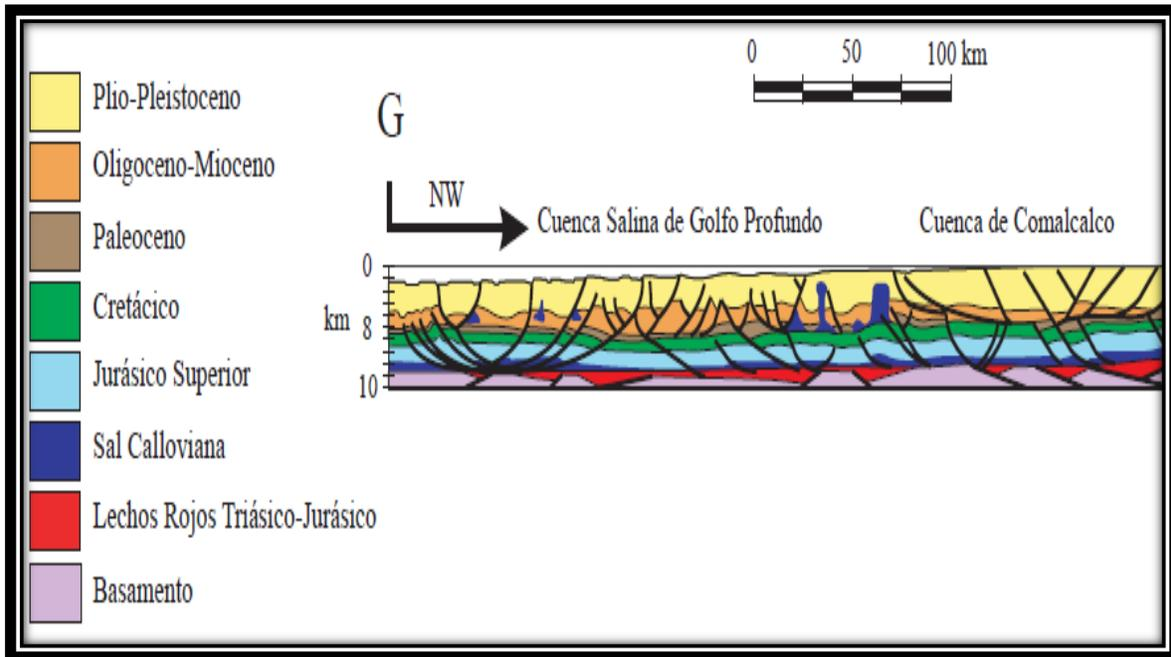
2.10 Esquema de una sección geológica representativa de la Cuenca Salina del Golfo Profundo y de la Cuenca de Comalcalco.<sup>48</sup>
