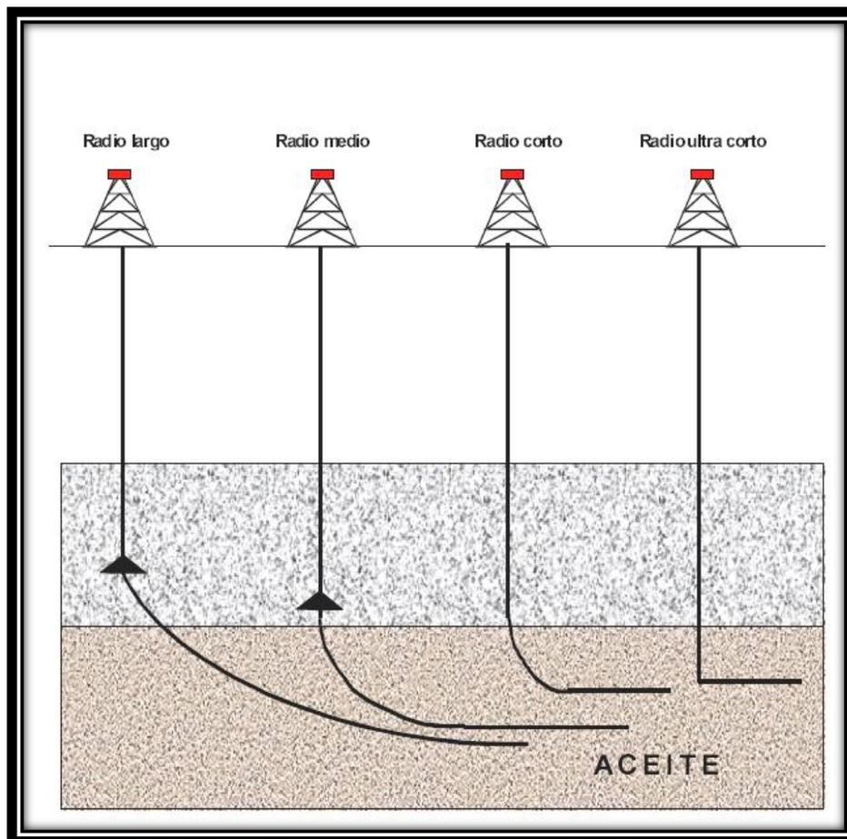
Figura 4.12 Ilustración de los métodos de curvatura.<sup>17</sup>
