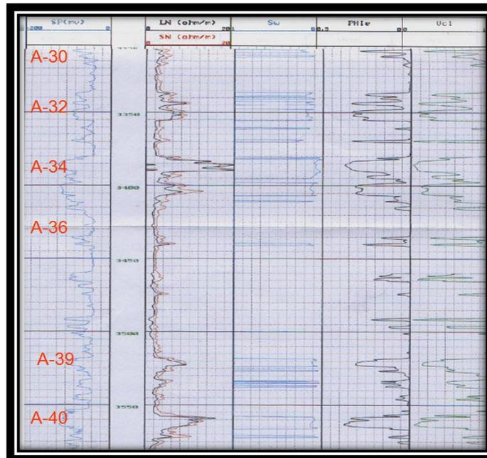
Figura 5.13 Registro geofísico indicando posibles arenas productoras.<sup>15</sup>
