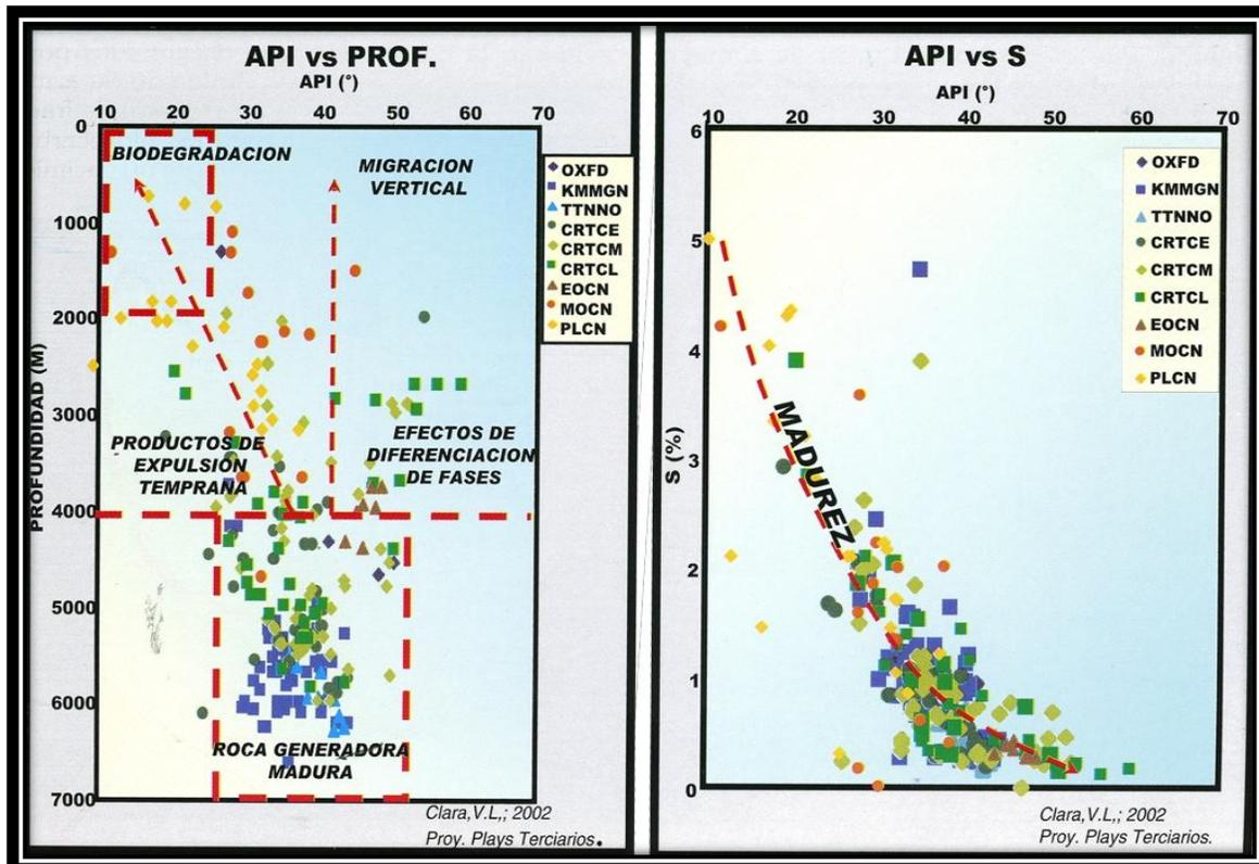
Figura 3.14 Comportamiento a profundidad de API y contenido de azufre, mostrando una tendencia normal de madurez en los aceites.<sup>33</sup>
