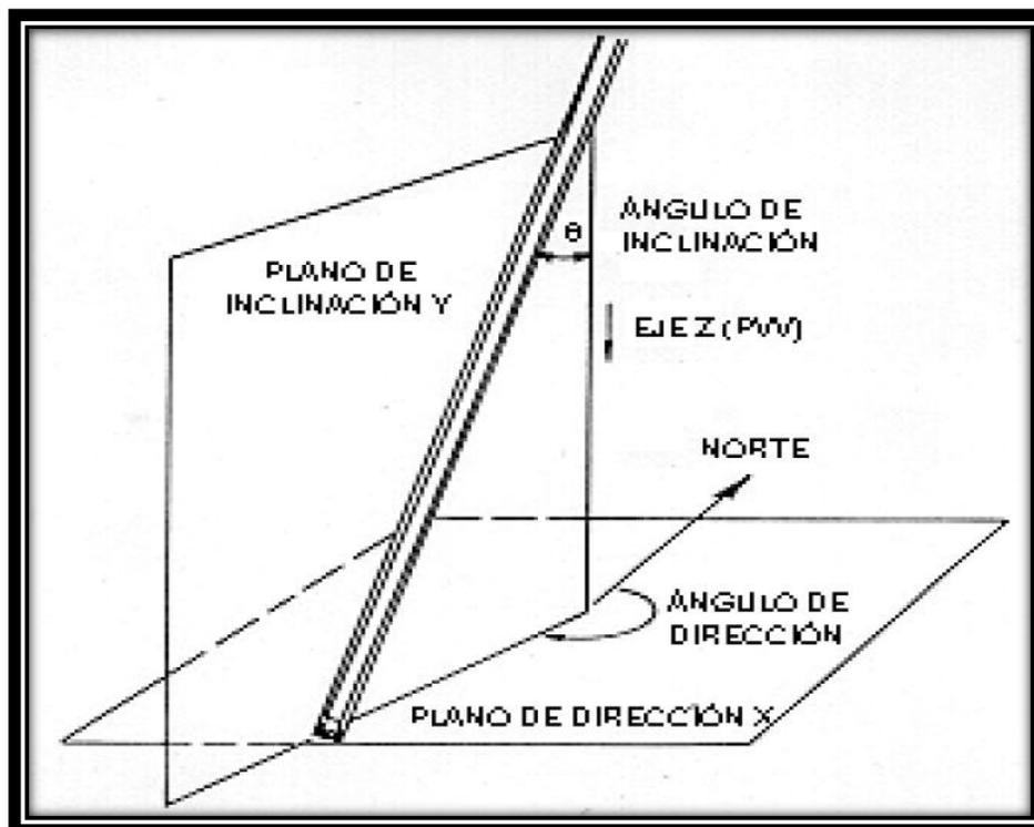
Figura 4.1 Planos de inclinación y dirección conforme un pozo avanza en el plano de profundidad.<sup>5</sup>
