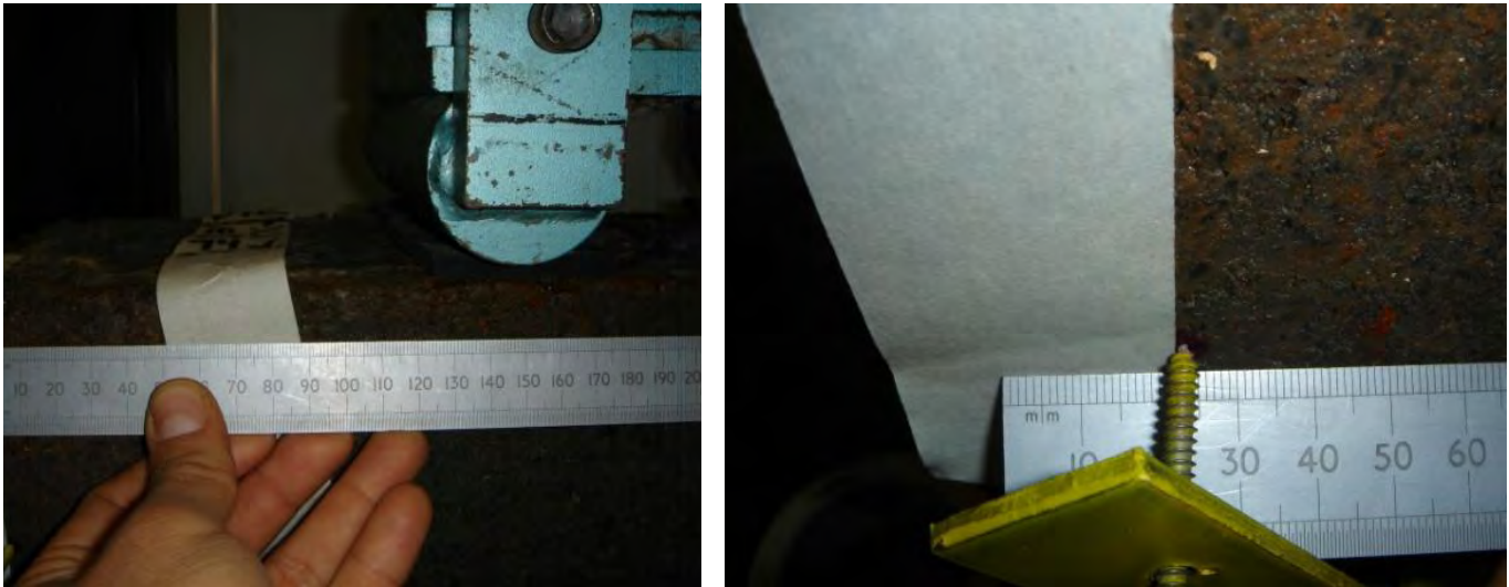
Figura 4.33. Medición del espécimen para colocar el arnés del LVDT
