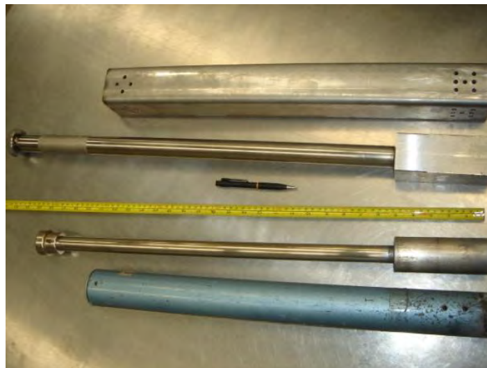
Figura 4.8. Pisonos empleados para compactar especímenes prismáticos (parte superior) y con molde Proctor estándar (parte inferior)
