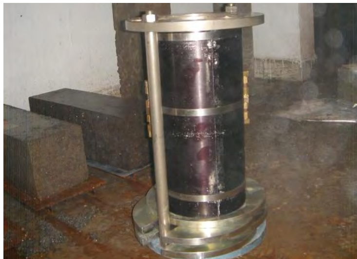
Figura 4.30. Molde para elaborar probeta cilíndrica ubicada en el cuarto de curado
