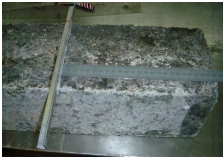
Figura 4.34. Barra de aluminio para transmitir deflexión del espécimen hacia LVDT
