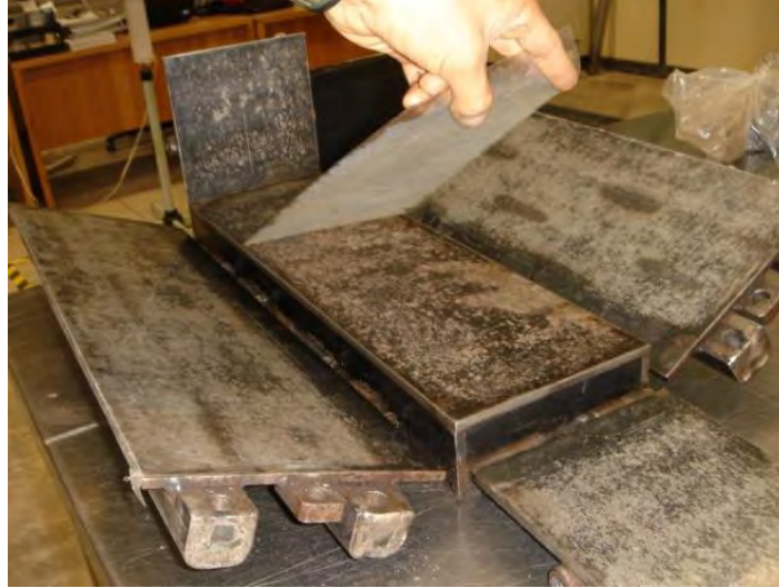
Figura 4.24. Colocación de la mica adherible sobre la placa base del molde para elaboración de varias vigas en el mismo día
