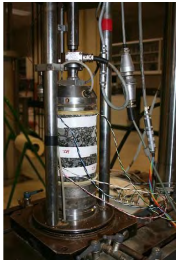
Figura 6.3. Instrumentación de probeta con strain gauges
