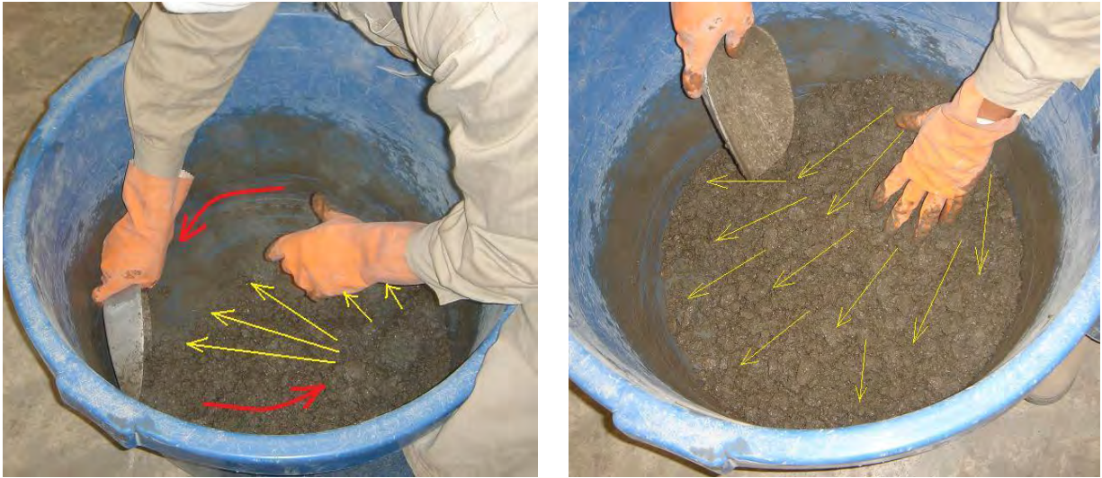
Figura 4.26. Mezclado del material para homogeneizar el material tanto en lo que se refiere a los agregados como a la humedad
