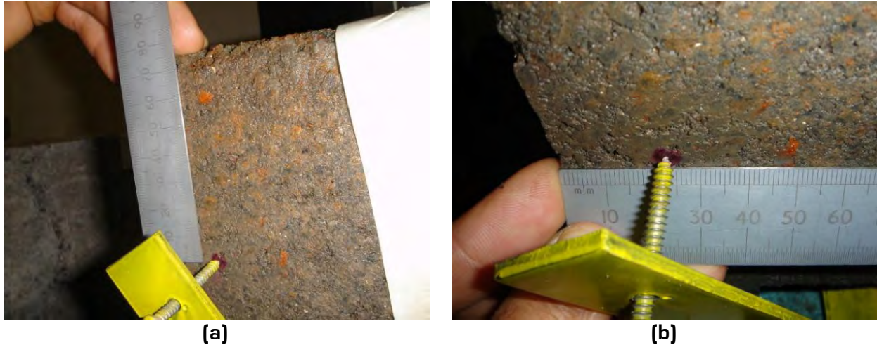
Figura 4.22. (a) Identificación del punto teóricamente libre de efectos mecánicos, (b) anclaje del arnés al espécimen por medio de pijas para obtener un área de contacto mínima y reducir la posibilidad de influir en su comportamiento mecánico
