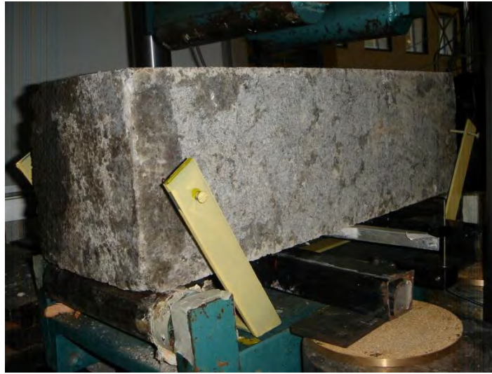
Figura 6.11. Viga colocada sobre base para prueba a flexión
