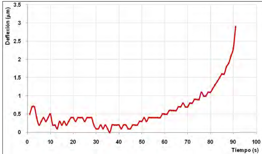
Figura 6.17. Deflexión plástica generada en un espécimen a fatiga
