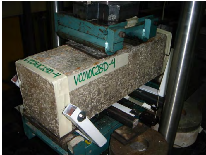
Figura 6.57. Textura en las vigas con mayor uniformidad
