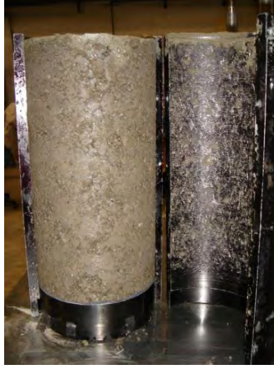
Figura 4.31. Extracción de la probeta cilíndrica del molde
