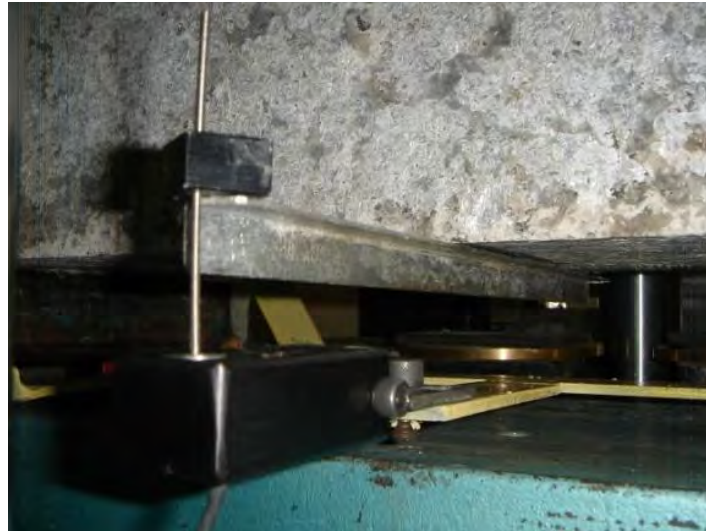
Figura 4.35. Arreglo para instrumentar las vigas con un LVDT para obtener la medición de la deflexión máxima al centro de la viga
