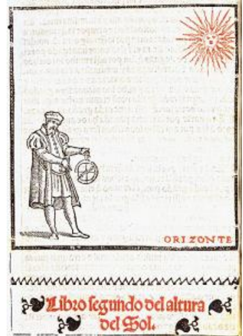
Ilustración 7. Medición de la altura del sol con un astrolabio. Libro segundo del Regimiento de navegación de Pedro de Medina. Sevilla, 1563.
