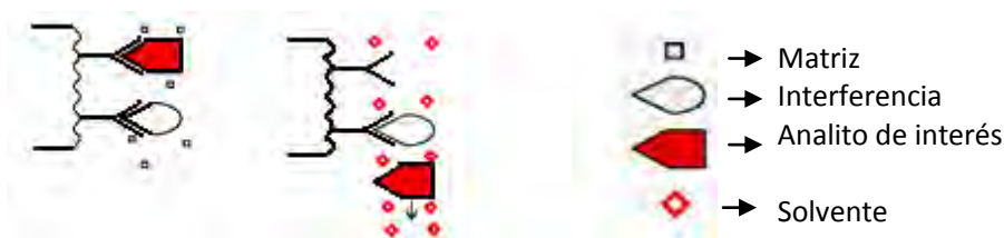
Figura II.12. Proceso de lavado cuando el analito interactúa con la fase estacionaria más débilmente que las impurezas provenientes de la muestra.
