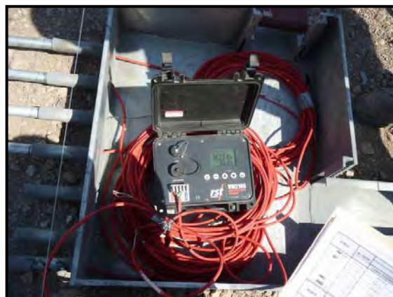
D. Medición inicial de la célula de presión
