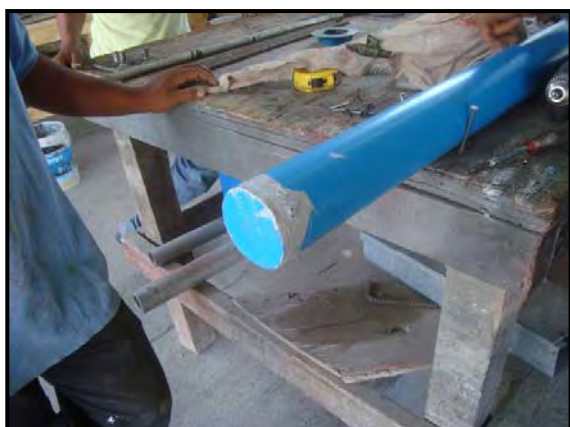
C. Una vez colocado el pasador es sella con un tapón y se coloca el Sikaflex en el exterior
