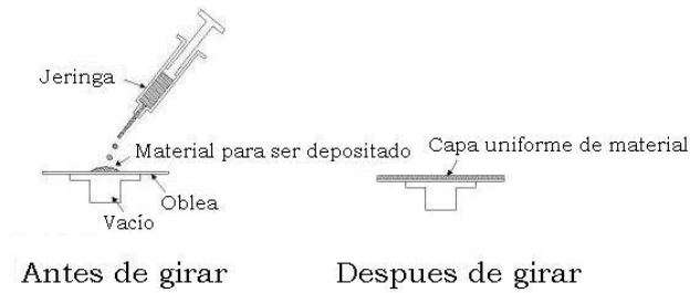
Figura 1.12: Proceso moldeado por giro [24].
