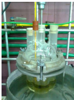
Figura 11. Reactor por lotes para llevar a cabo la reacción de transesterificación.
