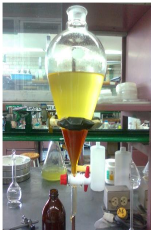
Figura 13. Separación de las fases producidas después de la reacción de transesterificación.
