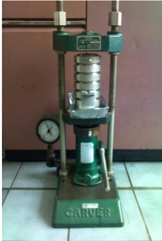
Figura 7. Extracción de aceite de semilla de Jatropha curcas con la prensa Carver.
