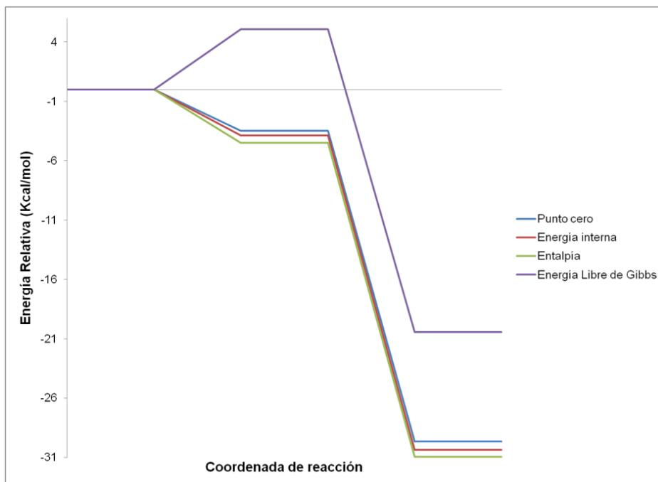
Figura 4.11. Perfil de reacción para la adición del radical hidroxilo al *cis*-buteno, con el nivel de cálculo CBS-QB3//MP2/6-311++G(d,p)
