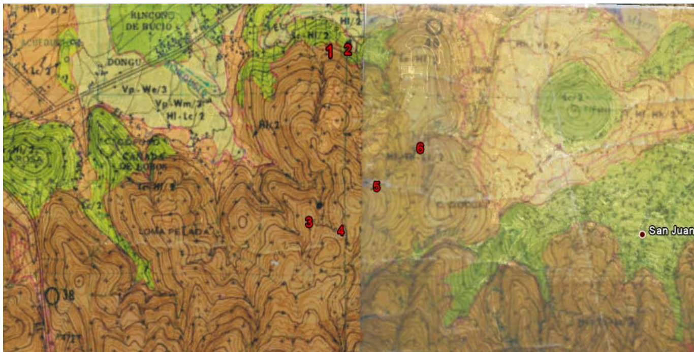
Figura 7. Se muestra la ubicación de los sitios de muestreo en las unidades de suelo. Fuente: Carta Edafológica INEGI. Esc. 1:50 000 (E14 A17 Atlacomulco y E14 A 18 Tepeji del Río).
