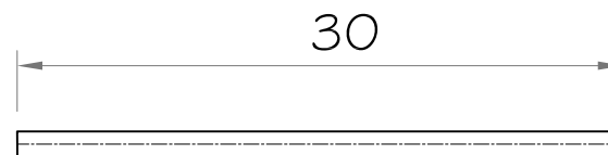
Barra de armado B tubo cuadrado 1/2"
