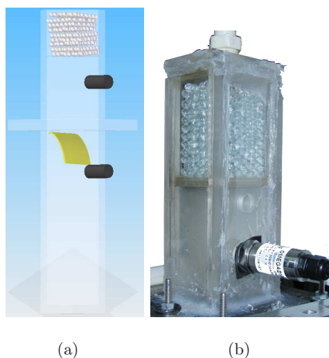
Figura 2.5.: Canal de pruebas. (a) Esquema del canal de pruebas para las valvas de silicón. Se muestra el lugar en el que se colocan las membranas para su estudio. (b) Zona de laminarización en la parte superior del canal de pruebas.
