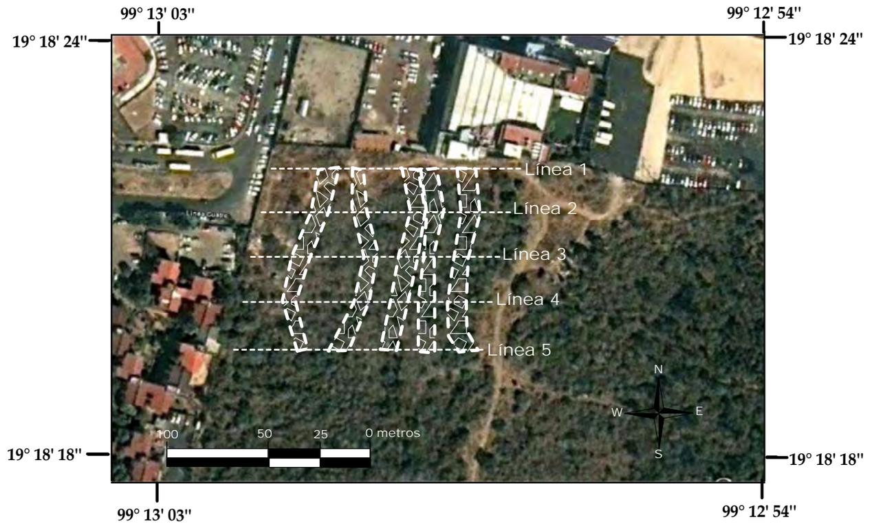
**Figura 6.9** Mapa de los tubos lávicos, obtenidos a partir de los modelos 2D con la configuración Wenner-Schlumberger, profundidad de 6 a 12m y longitud de 3 a 15 m.
