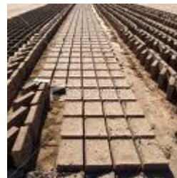
Fig. 6 Secado de Ladrillos de Adobe
