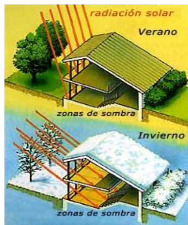
Fig. 69. Incidencia de los Rayos Solares
