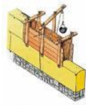
Fig. 7 Construcción de Muro de Tapial Fig. 8 Muro de Tapial
