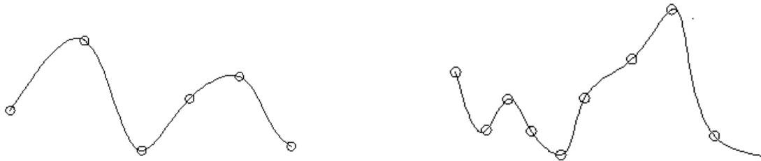
**Figura 3.10.** Interpolación con Spline.
