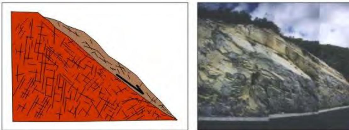
**Figura 2.3.-** Ejemplo de falla plana en calizas. Carretera a la Presa Zimapán.
