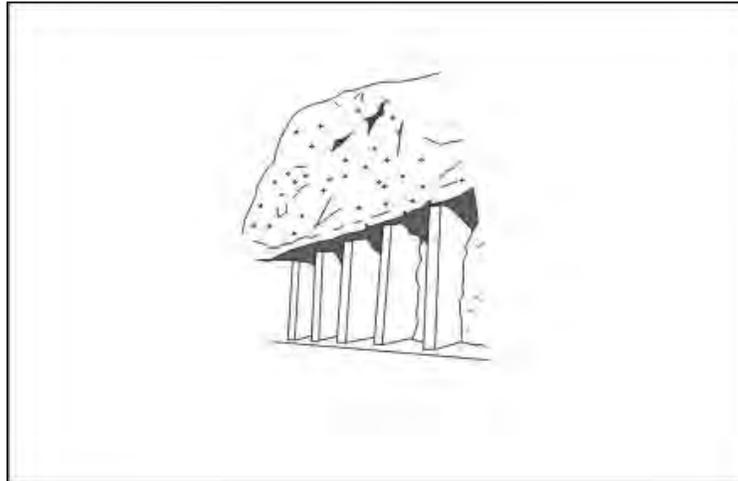
**Figura 7.9.-** Muros de apeo para estabilizar bloques rocosos en cantiléver.
