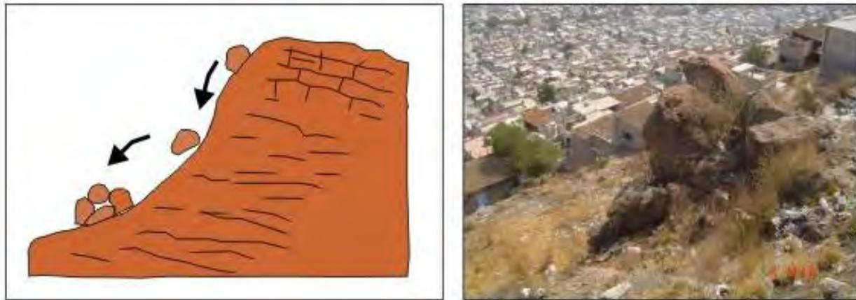
**Figura 2.8-** Ejemplo de una caída por rodamiento, municipio de Ecatepec, en la Sierra de Guadalupe. Se trata de un grupo de bloques separados e independizados de la masa rocosa.
