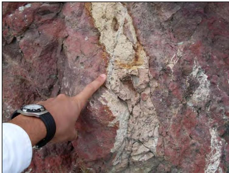
**Figura 4.3.-** Brecha cohesiva de falla localizada en los cortes realizados en el Peñón.
