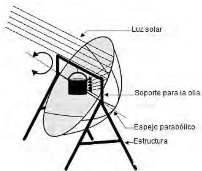
Figura 3.10: Cocina solar de concentración
