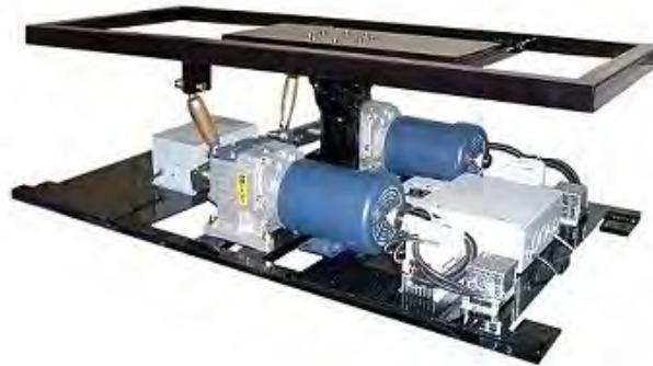
Figura 1.1. Plataforma con 2 grados de libertad (Fuente: http://www.inmotionsimulation )
