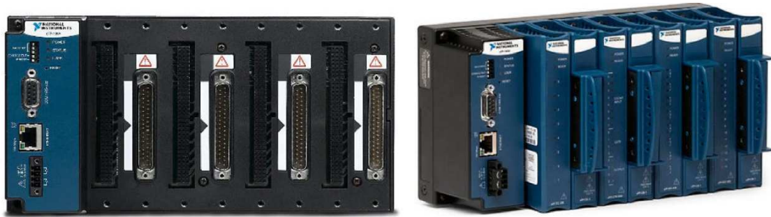
Fig. 3- 19 Sistema de adquisición de datos Compact Field Point 1804, cFP-1804[Error! No se encuentra el origen de la referencia.]
