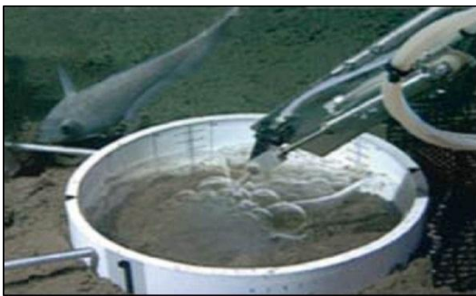
Fig. A 1.45 Formación de fosas cuando el \text{CO}_2 líquido se libera a 3600 m
