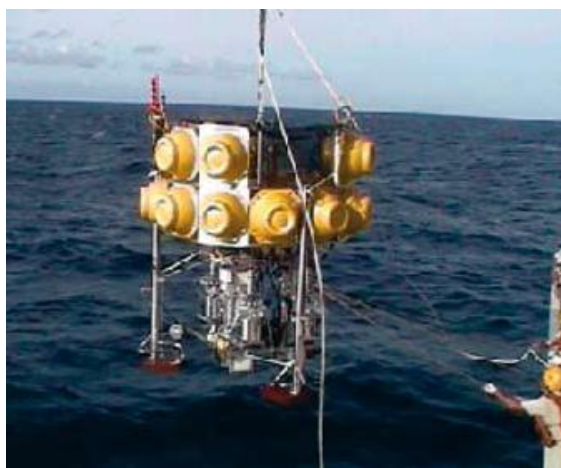
Fig. 6.1 Cámara experimental que va en el fondo del mar
