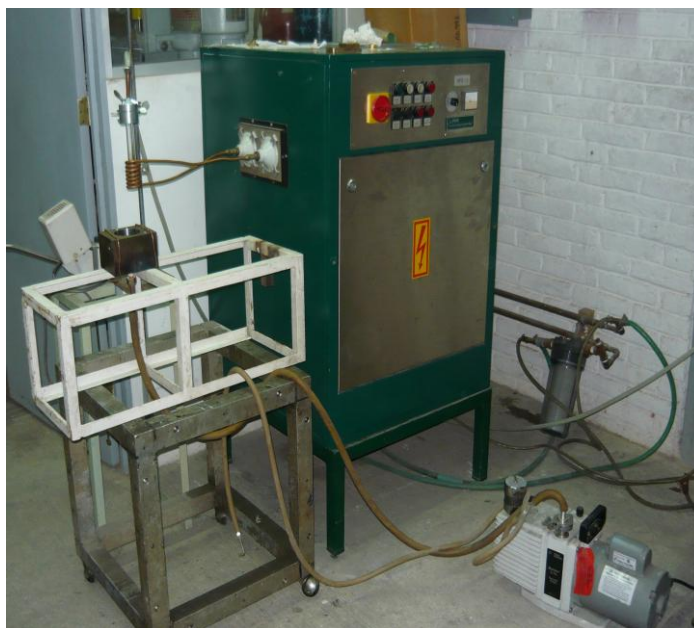
Figura 24.- Dispositivo montado para realizar la fusión por inducción de la aleación.
