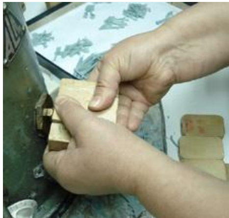
Figura 45.- Inyección de cera.
