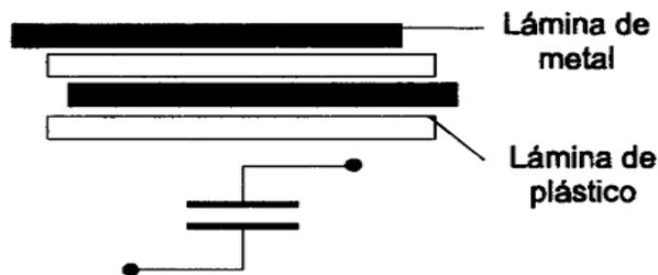
**Figura 3.3. Construcción y conexión interna para los capacitores KS y KP.**
