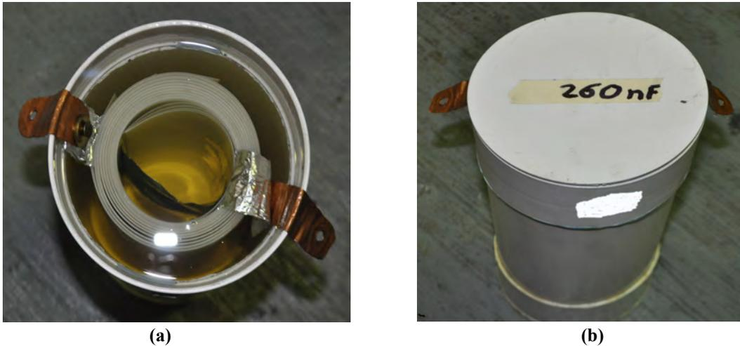
**Figura 3.6. Apariencia final del capacitor construido.**
