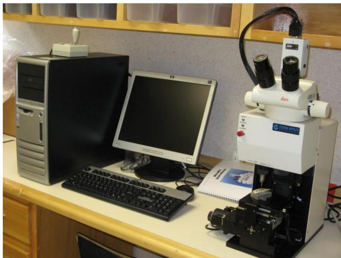
**Figura 19.** Sistema de obtención de muestras de tejidos duros (dientes, vértebras, otolitos etc). El equipo programa el paso de un mini-taladro sobre la superficie del diente a una profundidad, longitud y anchura pre-determinadas.
