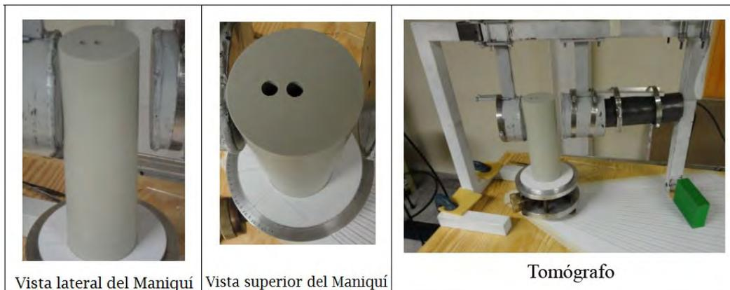
Figura 4.2: Diseño experimental que se uso para obtener el tomograma
