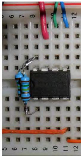
Figura 5.1 AD620 en protoboard para efectuar pruebas.
