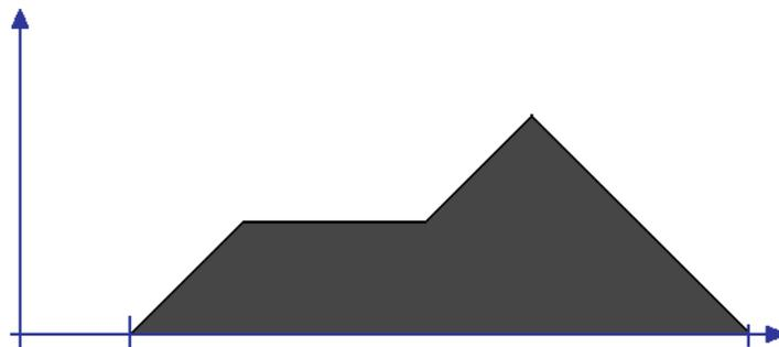
**Figura 3.21. Conjuntos Difusos de salida, aplicando el método de Máximo**
